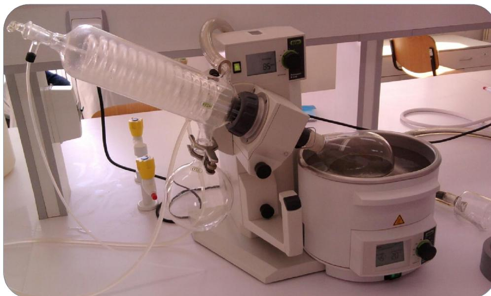
**Figure 09.** Evaporation des extraits par rotavapeur (R-210 BUCHI).
