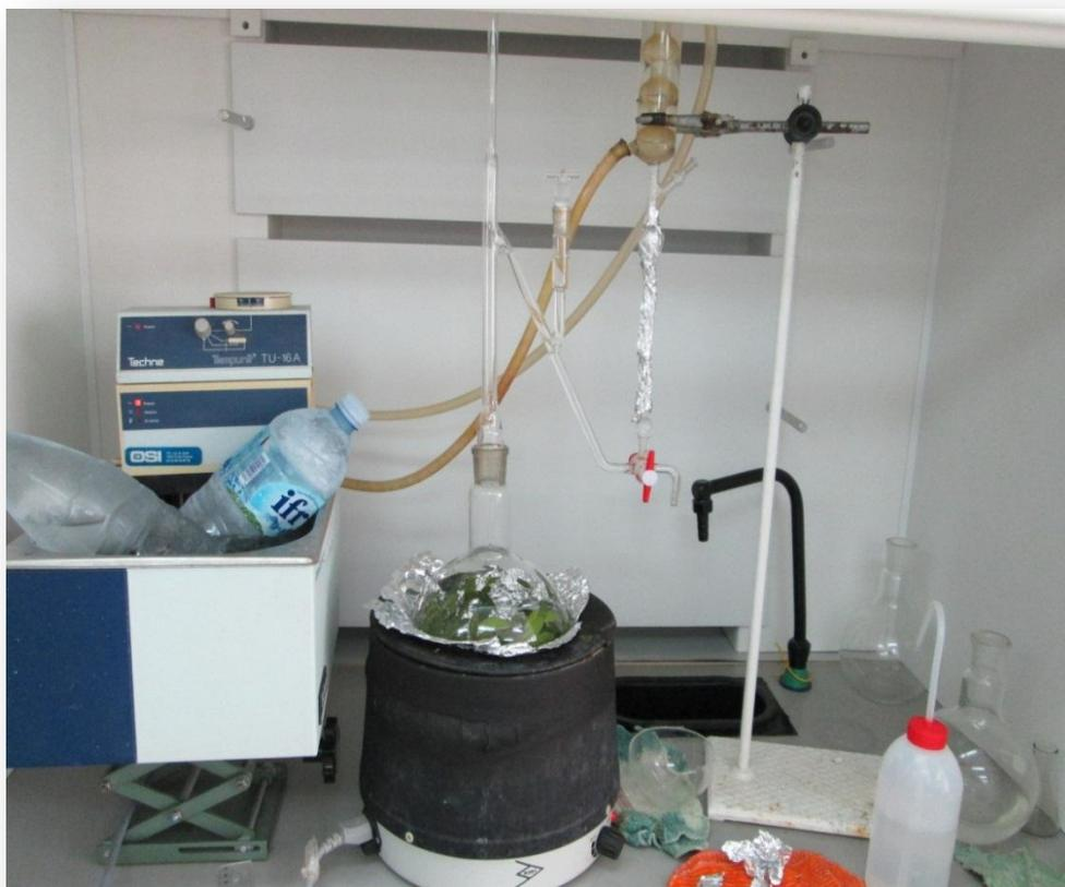
**Figure. 08 :** Montage d'hydrodistillation utilisé pour l'extraction de l'huile essentielle de *Pistacia lentiscus*
