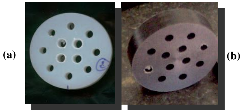
Figure I.25: Matériaux utilisés : (a) Polyamides non renforcés (PA6), (b) Polyamides renforcés avec 30% de fibres de verre (PA66 GF30) [71].
