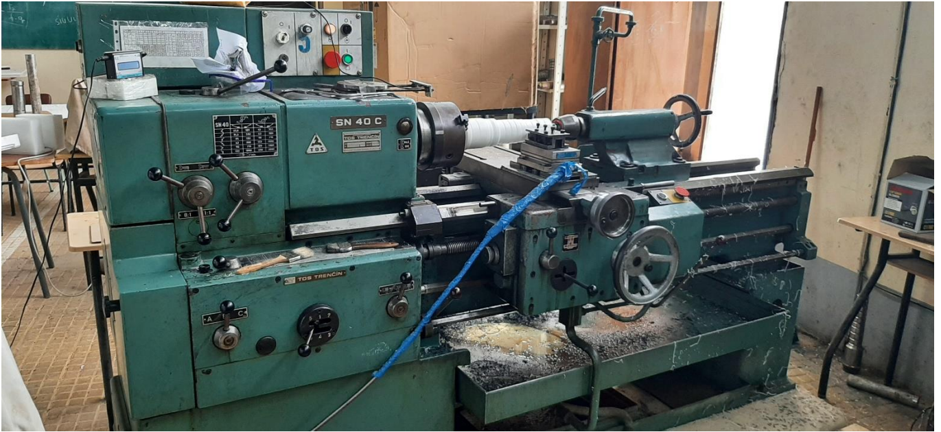
Figure II.1 Tour parallèle modèle SN40.
