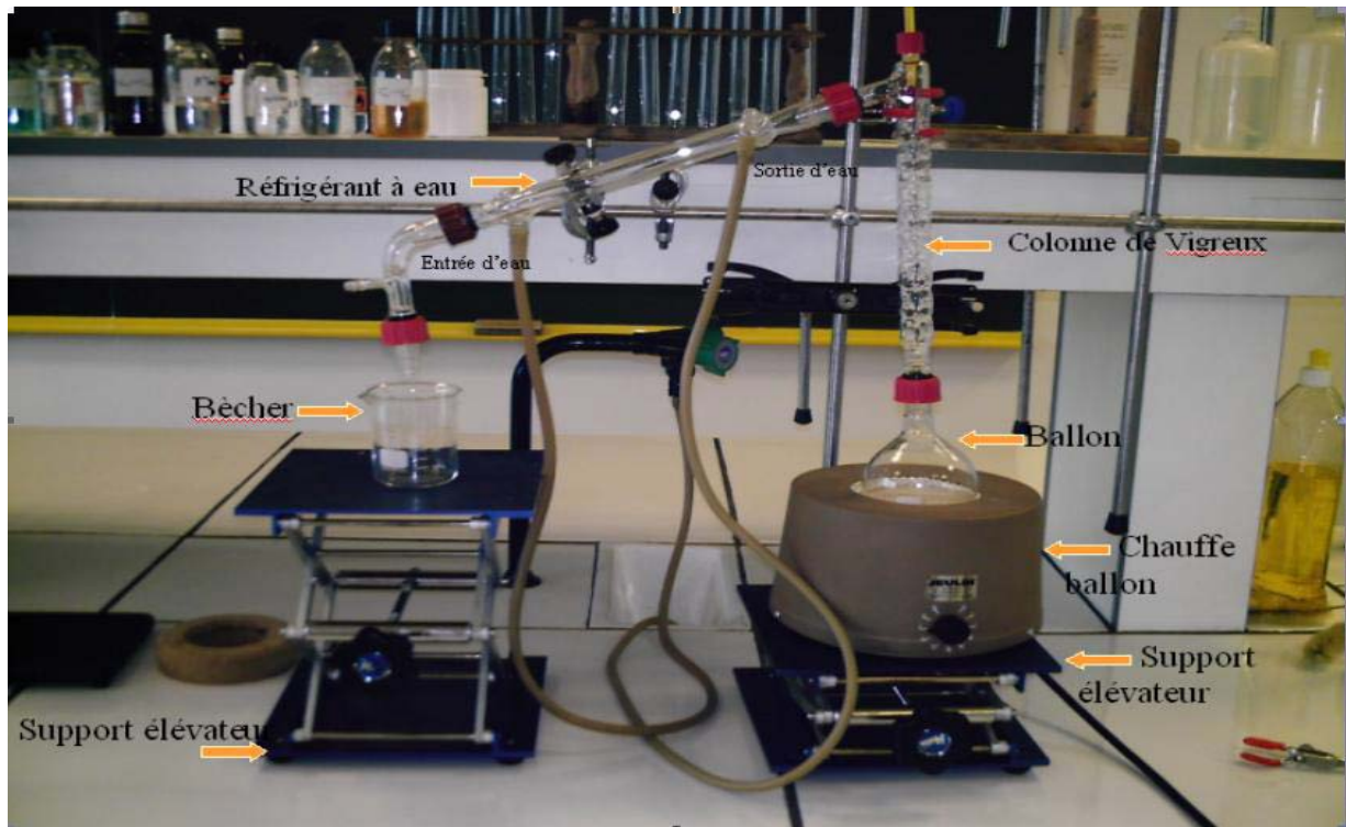
Figure 06 : Un hydrodistilateur et leurs composées[47].
