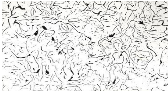
Figure I.9 Structure Microscopique d'une fonte grise[22]
