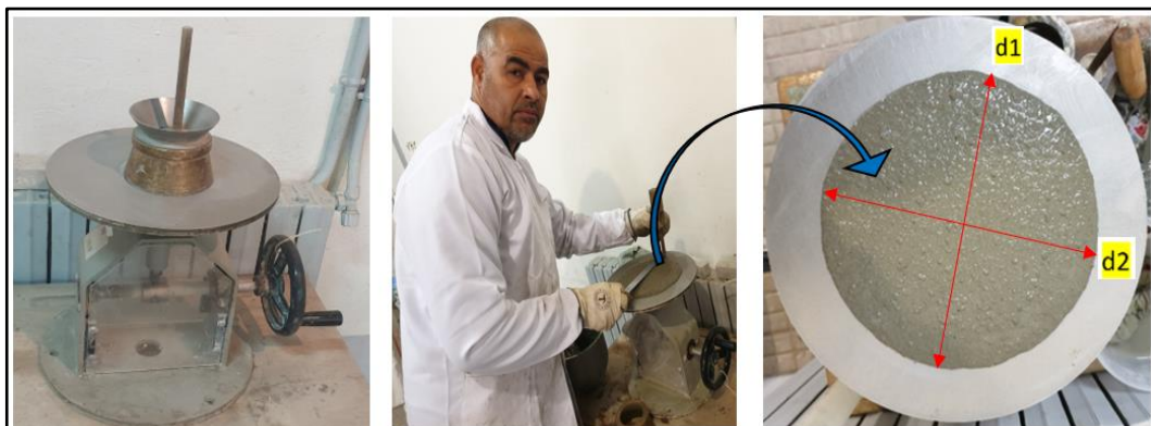
Figure III-13 : Equipements tables à secousses et méthode de la mesure de l'étalement.
