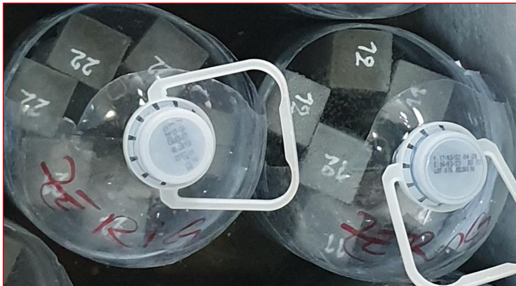
Figure III-25 : Principe expérimental d'absorption d'eau.
