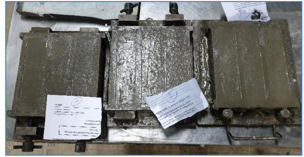
Figure III-11 : Nivellement de la surface du mortier avec une truelle.
