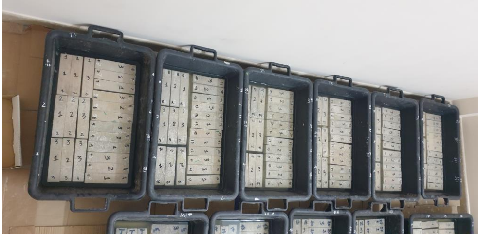
Figure III-27 : Essai de l'attaque d'acide H_2SO_4 sur les éprouvettes (4x4x16) cm^3
