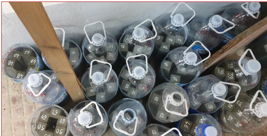
Figure III-12 : Conservation des échantillons d'essai dans l'eau.
