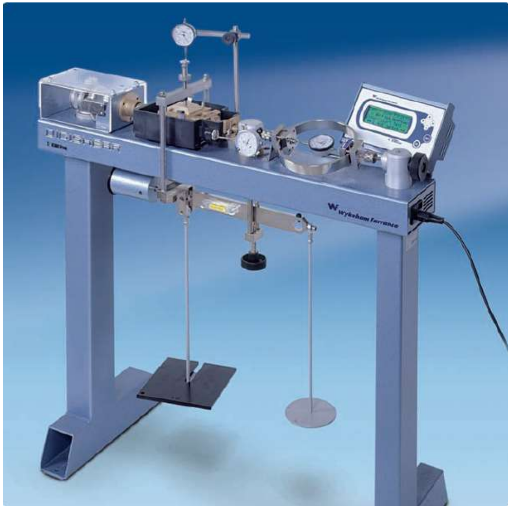
Figure 3.2 : Le bâti métallique de l'essai de cisaillement direct
