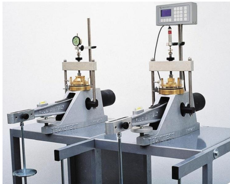
Figure 2.1 : Vue générale de l'oedomètre
