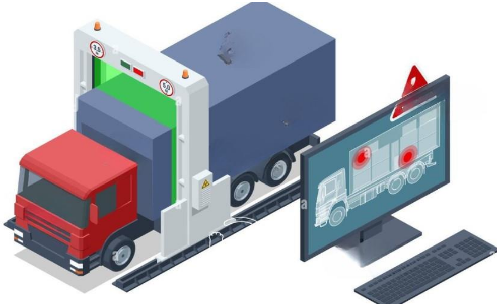
الشكل 12: لمحة عن طريقة فحص الحاويات بالأشعة السينية
