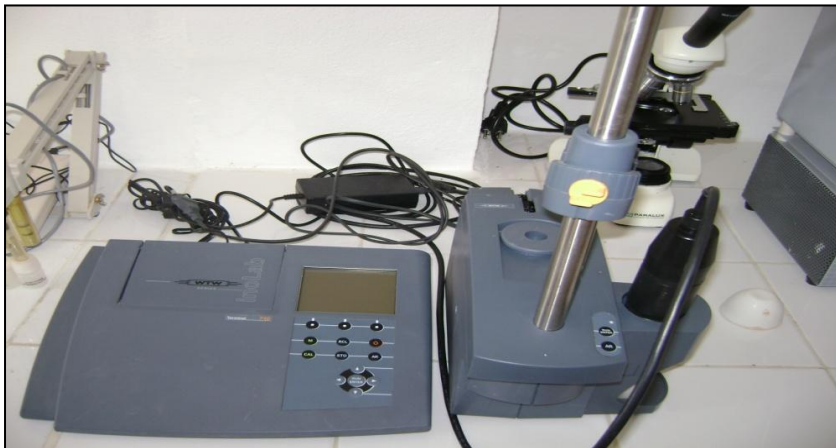
Figure.20 : L'installation pour mesurer la DBO 5 . (STEP Guelma, 2008).
