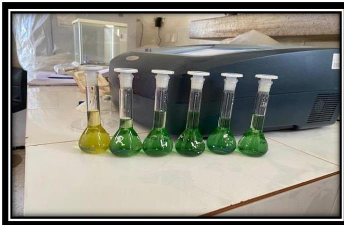
**Figure 22 : Analyses de l'Ammonium**
