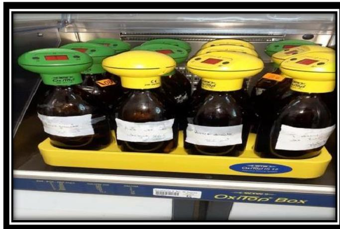
**Figure 27 : Appareil DBO mètre**
