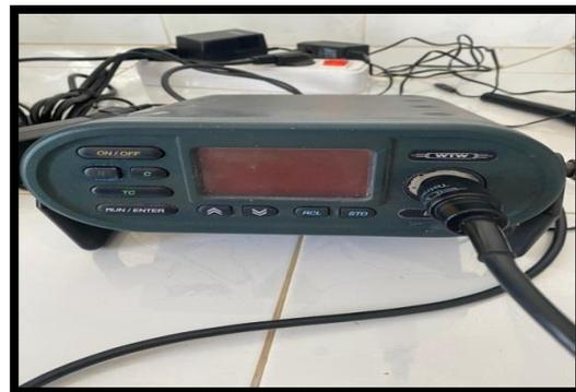
**Figure 18 : multi paramètre (WTW LF197)**
