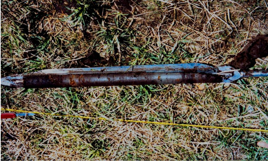
Figure 6 : Carottier Russe et carotte tourbeuse de 60cm de longueur (Berredjem et mokhnache ,2023)
