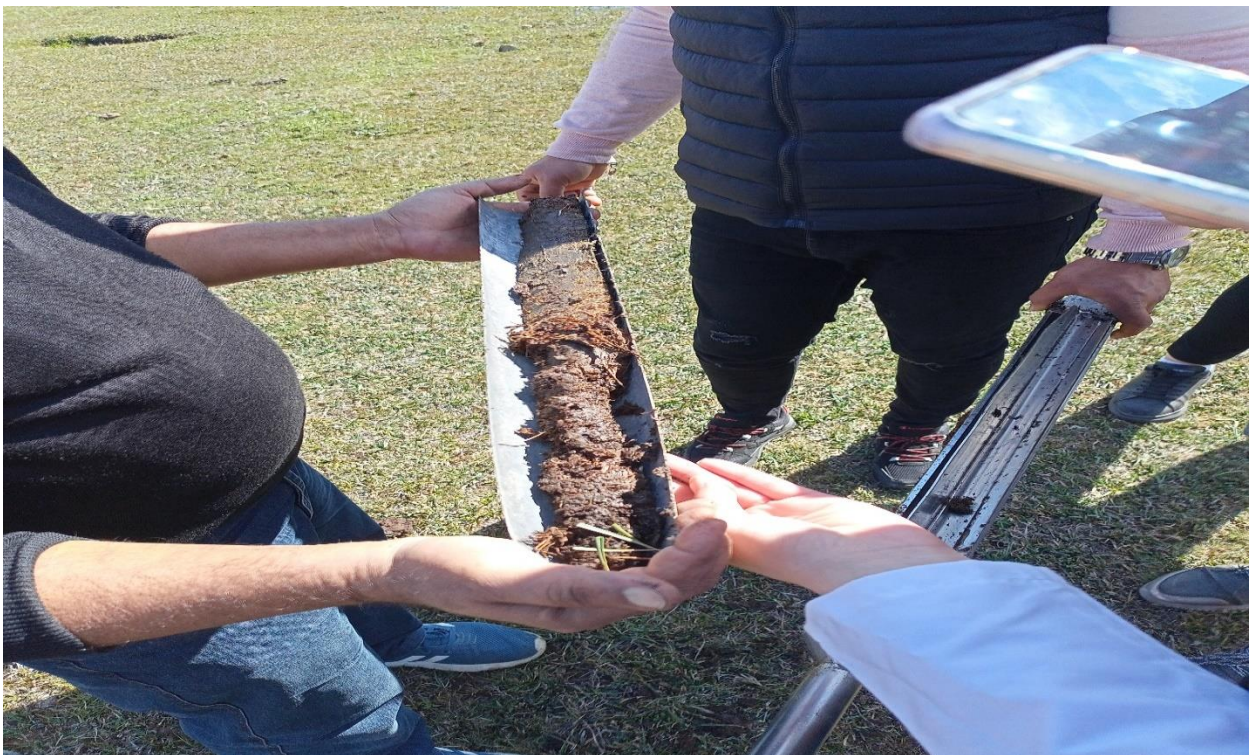
Figure 7 : Carottier Russe et carotte tourbeuse de 60cm de longueur (Berredjem et mokhnache ,2023)
