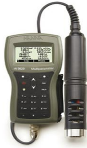
(a) Appareil de mesure des paramètres de la qualité de l'eau (multi-paramètre de terrain)
