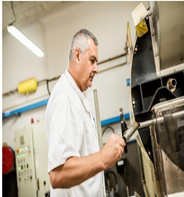
Figure 22 : Le processus de cuisson des grains de café vert à l'intérieur du tambour.
