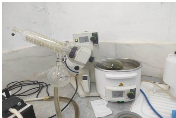
L'évaporation du solvant à l'aide d'un rotavapeur
