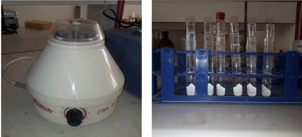
**Figure 41: récupération de la suspension en utilisant une centrifugeuse.**
