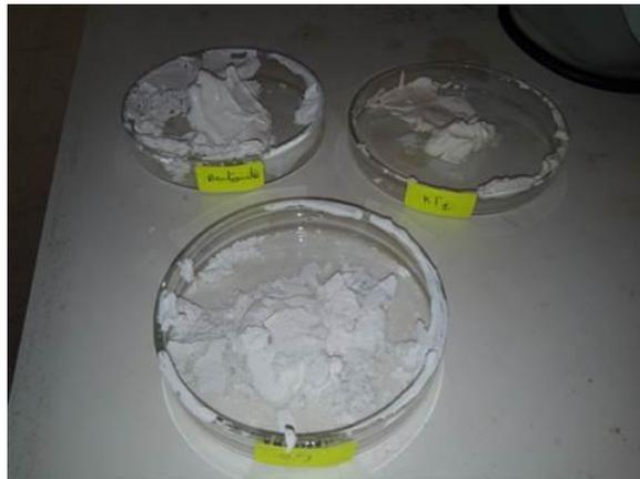
**Figure 42 : Les argiles modifiées par  $\text{TiO}_2$  traitée.**
