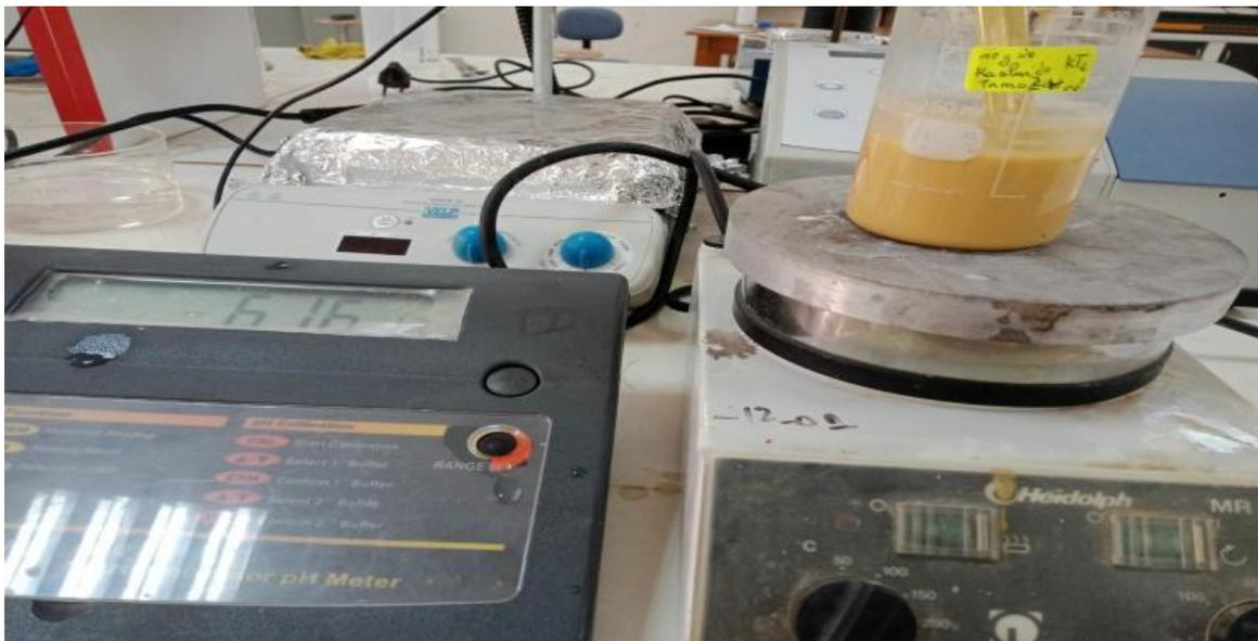
Figure 20 : Mesure du pH.
