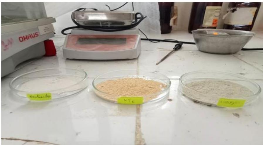
**Figure 21: Mesure de la masse de l'échantillon d'argile (bentonite, DD3, KT2).**
