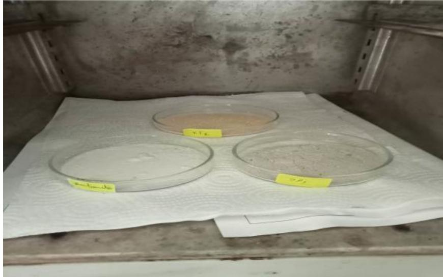
**Figure 22 : Étape de séchage à 110°C pour obtenir une masse constante de l'échantillon d'argile.**
