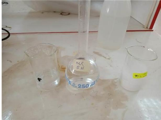
**Figure 35: Préparation de la solution de pontage (HCl, TiO<sub>2</sub>).**
