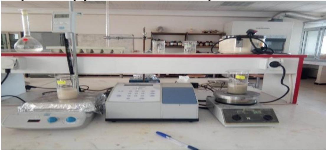
**Figure 27: Agitation du mélange argile-eau-MgO pendant 5 minutes à l'aide d'un agitateur.**
