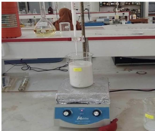
**Figure 38 : Titrage de l'argile par  $\text{TiO}_2$ .**
