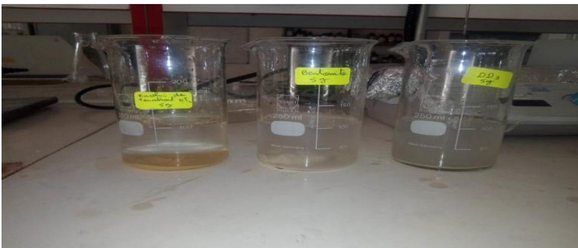
**Figure 26: Préparation de la suspension d'argile avec ajout de MgO pour la défloculation.**
