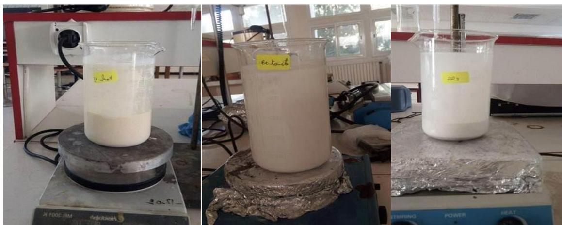
**Figure 39 : Solution  $\text{TiO}_2$  avec l'argile sous agitation pendant 12 heures à  $25\text{ }^\circ\text{C}$ .**
