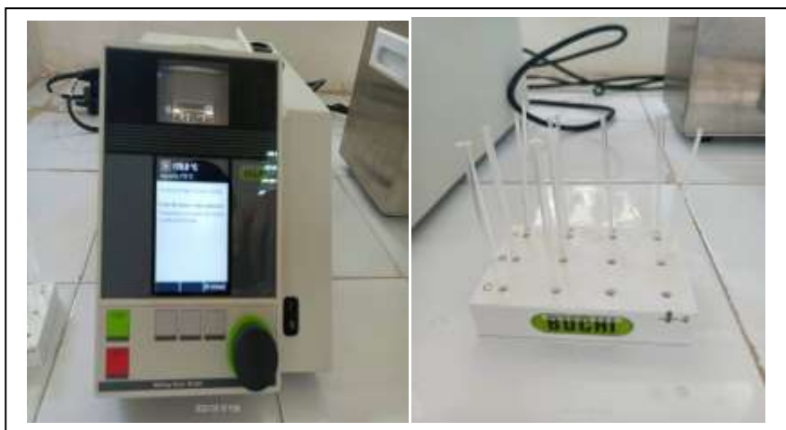
Figure 4.5 : Appareil Point de fusion M-560 BUCHI utilisé.
