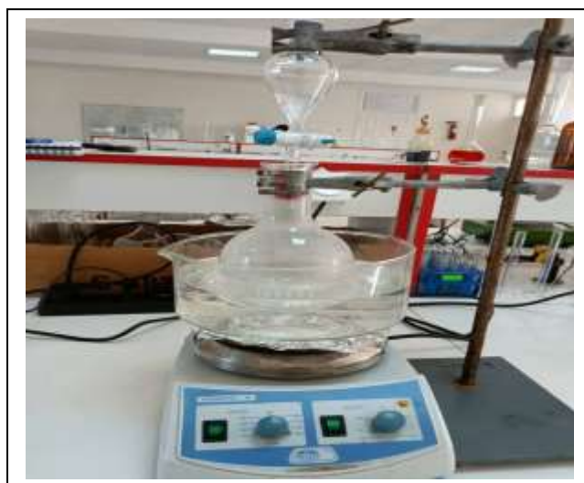
Figure 4.9 : Synthèse du complexe HP- \beta -CD-SULP par co-précipitation.
