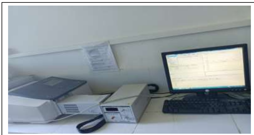
Figure 4.14 : Spectrophotomètre UV-Visible à double faisceau Shimadzu model UV 1800.
