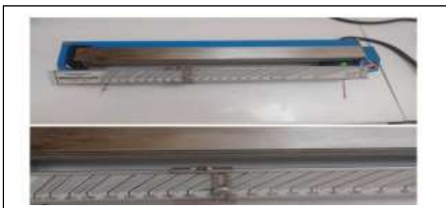
Figure 4.4 : Banc KOFLER utilisé pour la détermination des températures de fusion.
