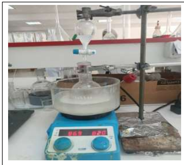
Figure 4.13: Synthèse du complexe Zn-SULP- \beta -CD par Co-précipitation.
