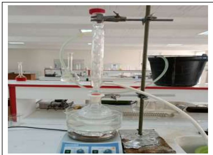
Figure 4.10 : Synthèse du complexe Mg-SULP par co-précipitation.
