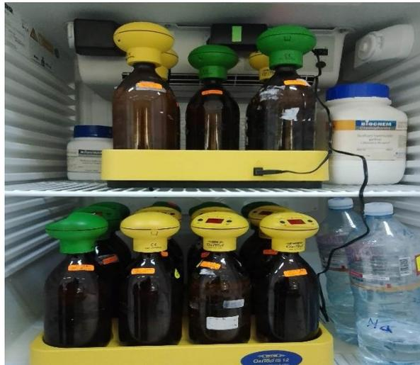
**Figure II.26 : DBO mètre.**
