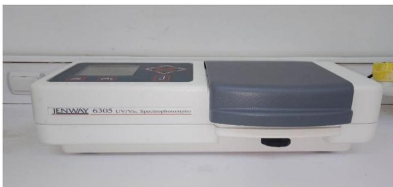
**Figure II.13 :** Spectrophotomètre UV-VIS JENWAY 6305.
