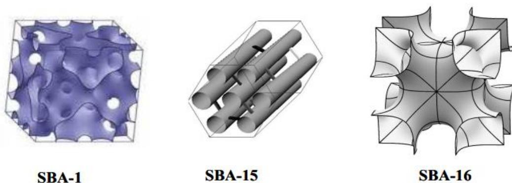
**Figure I.10** : Représentation schématique de quelques phases méso structurées de la famille SBA-n
