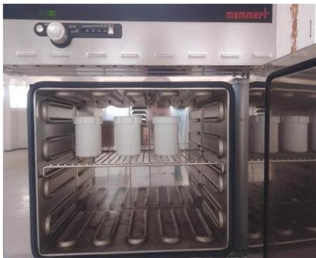
c) Autoclaves en Téflon dans l'étuve
