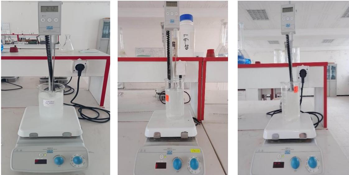
Figure II.23 : le protocole de l'adsorption des effluents pharmaceutique avec les trois matériaux mésoporeux.
