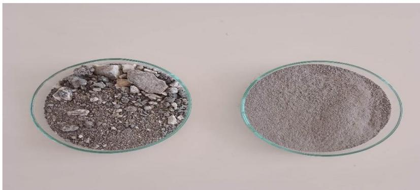
**Figure II.4** : L'argile avant et après traitement préliminaire.
