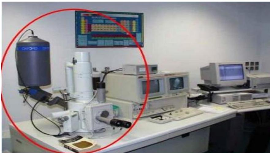
**Figure II.11 :** La microscopie électronique à balayage (MEB) de Biskra.
