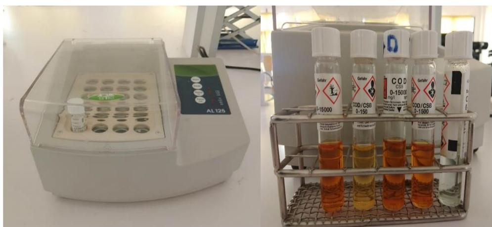
**Figure II.25 :** DCO mètre « le Bloc chauffant et les tubes des réactifs ».
