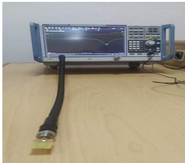
Figure III.12 : Analyseur de réseau de type Rohde and Schwarz.
