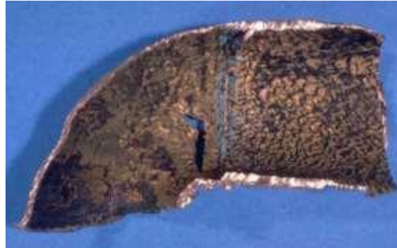
Figure I.15 : La corrosion érosion [12]
