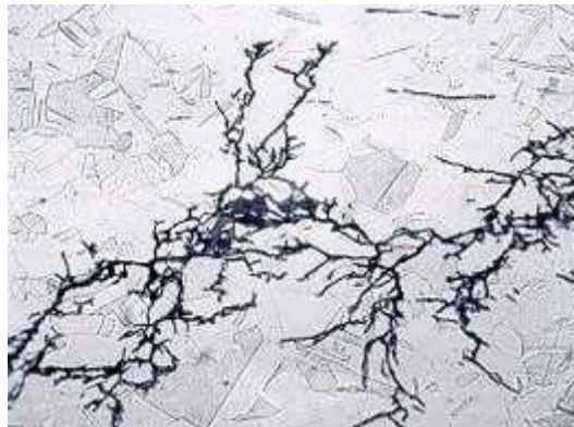
Figure I.16 : La corrosion sous contrainte [11].
