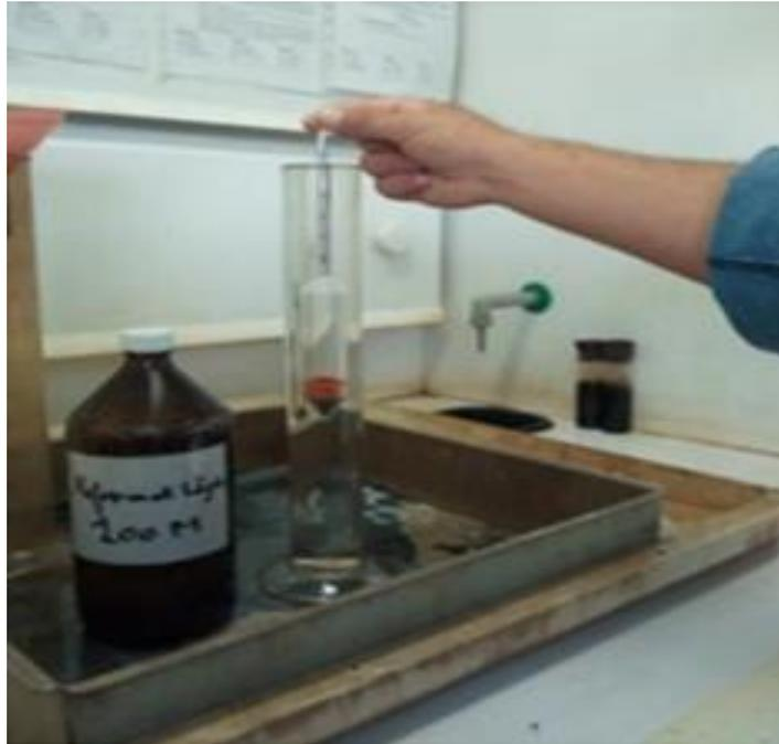
**Figure III.1:** Montage expérimental pour la détermination de la densité [1].
