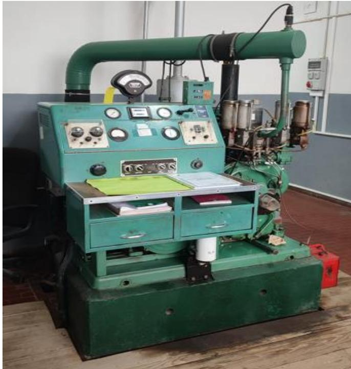
**Figure III.4:** Moteur CFR [1, 5].
