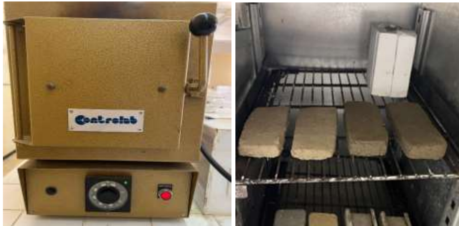
Figure IV. 11: Photos de l'étuve de type Memmert et du four de type Contrelab utilisés.
