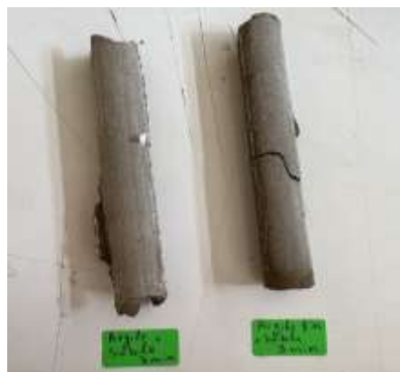
Figure IV. 8 : Aspect des membranes tubulaires élaborées à partir de la barbotine d'argile.
