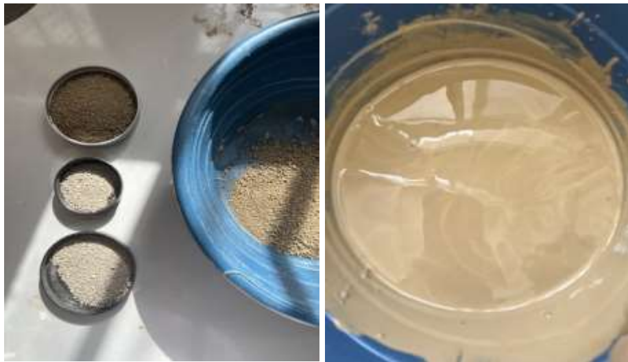
Figure IV. 6: Etapes de préparation de la barbotine d'argile.
