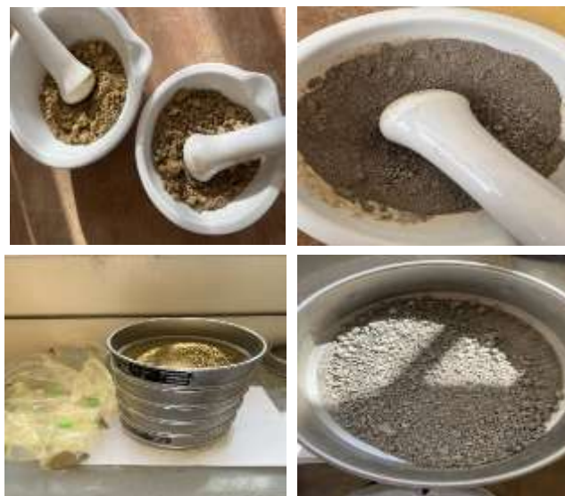
Figure IV. 4: Broyage et tamisage des pâtes séchées.
