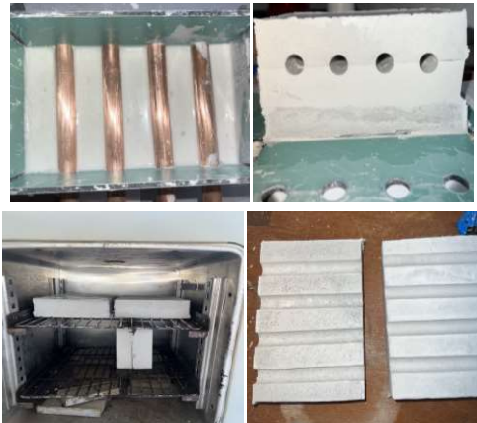
Figure IV. 5: Etapes de préparation des moules de plâtre.
