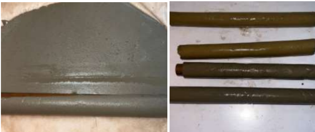
Figure IV. 10 : Etapes de fabrication des membranes tubulaires par étalage et moulage.
