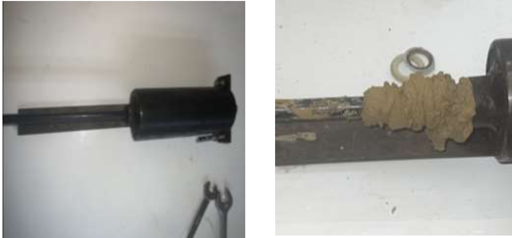
Figure IV. 9: Etapes d'extrusion de la pâte.
