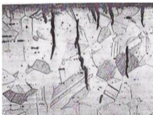
Figure I.4 : Corrosion sous contrainte dans le chlorure de magnésium d'un acier inoxydable [Benard.J, et al ; 1969].
