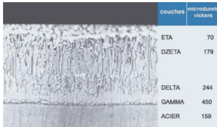
Figure II. 4 : Vue en coupe transverse de phases formées après la galvanisation de l'acier.
