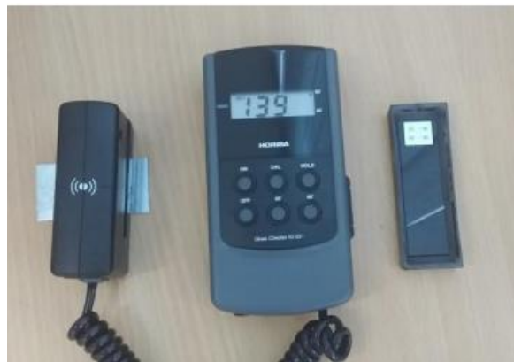
Figure III.4 : Brillance-mètre GLOSS CHECKER IG-331 (HORIBA).
