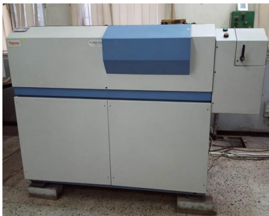
Figure III.2 : Spectromètre ARL 3460 au niveau de de l'unité Sider el hadjar section LAF.
