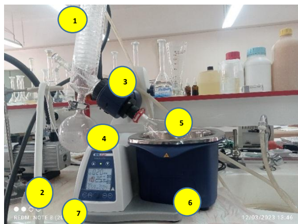
Figure III-4 : Séparation du solvant dans un évaporateur rotatif (rota vapeur)
