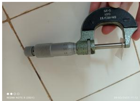
Figure III-9 : Micromètre pour la mesure de l'épaisseur des biofilms
