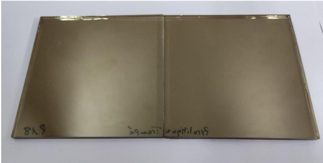
**Figure IV.51 :** Le côté glass de l'échantillon 2 après 18 min de trempe.
