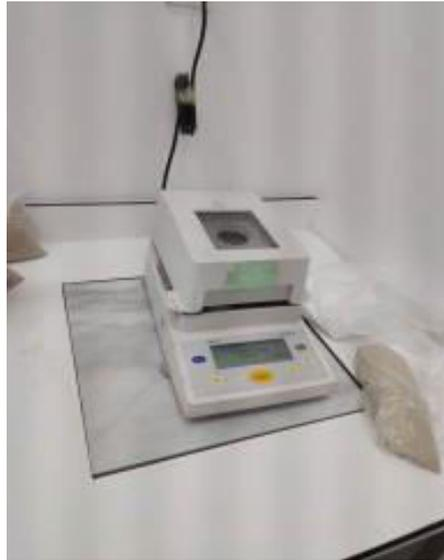
**Figure III.3 :** L'appareil de mesure du taux d'humidité.
