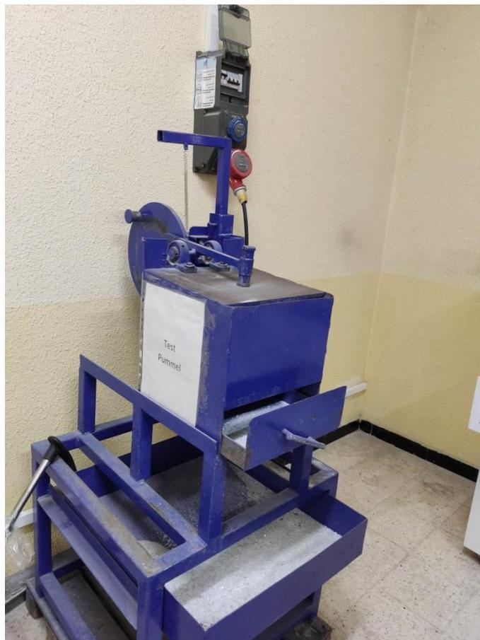
Figure III.10 : Appareil de test pummel
