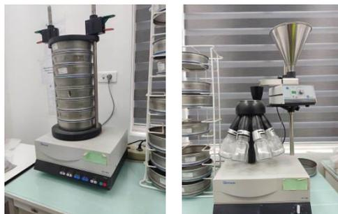
**Figure III.2 :** L'analyse granulométrique.
