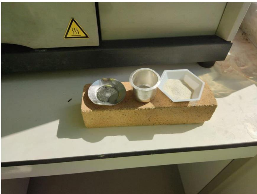
**Figure III.5 :** les produits utilisés pour la préparation de la perle
