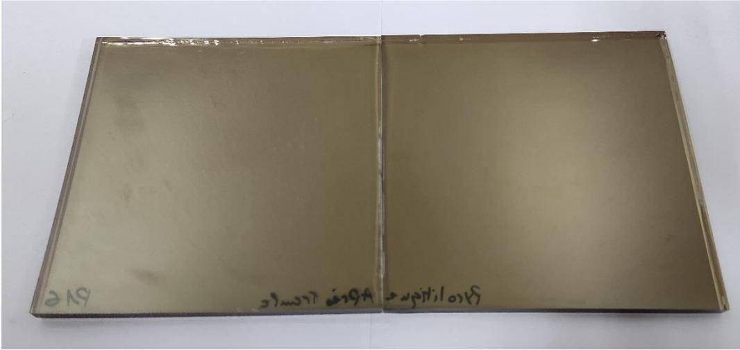
**Figure IV.46 :** Le côté glass de l'échantillon 2 après 16 min de trempe.
