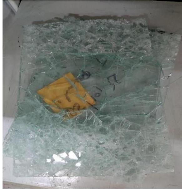
**Figure IV.16 :** Résultat de test pummel.
