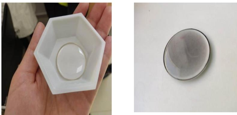
**Figure IV.3 :** L'échantillon (perle) avant et après l'analyse par fluorescence X.
