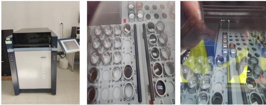
**Figure III.4 :** Spectromètre d'analyse de fluorescence de rayon X à MFG
