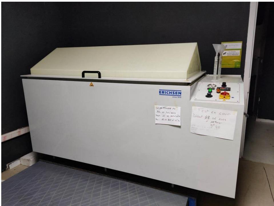
Figure III.13 : Test de corrosion brouillard salin neutre
