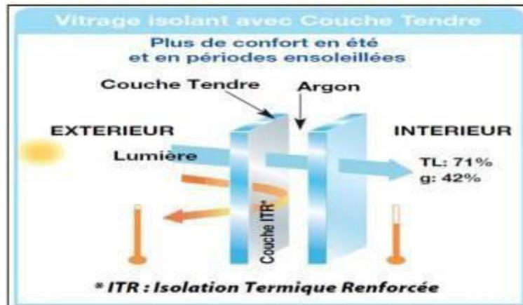
Figure I.12 : Fonctionnement optique du verre à couches
