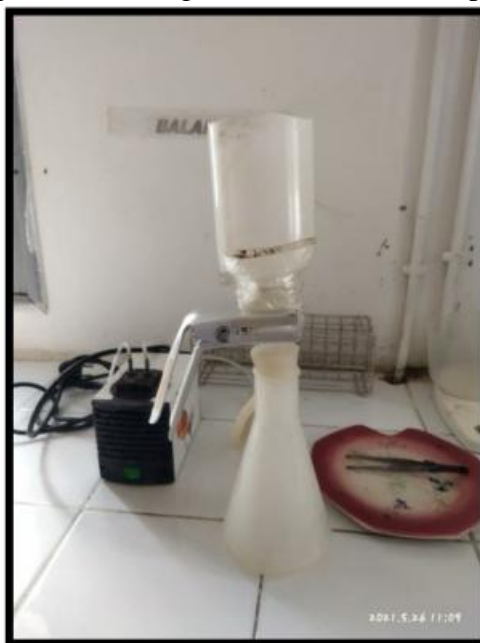
Figure 23 : Appareil de Dosage de la matière en suspension (MES)
