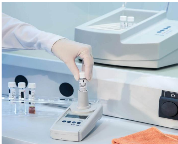
Figure 20 : Appareil de mesure de la DCO
