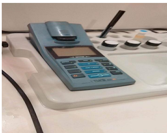
Figure19 : Appareil de mesure de turbidité
