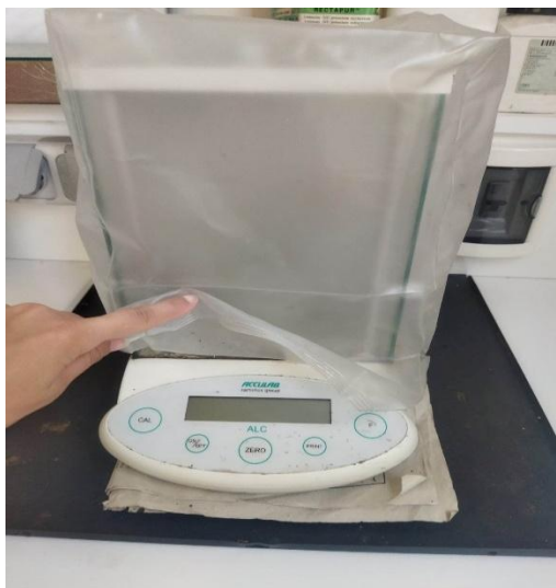
Figure 23 : Appareil de Dosage de la matière en suspension (MES)
