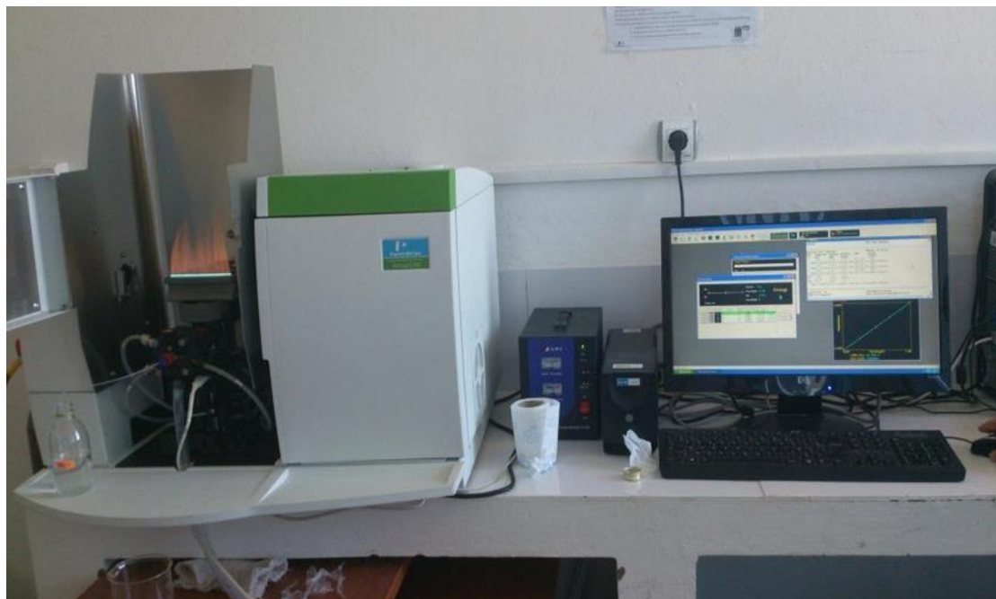
Figure III.1 : Spectrophotomètre d'absorption atomique AAnalyst 400 Perkin Elmer(L.A.I.G.M).
