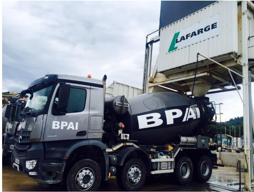
Figure I.3:Chargement du BPE dans un camion toupie
