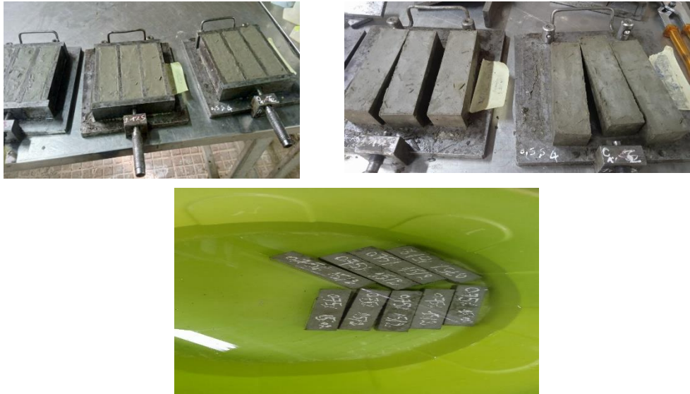
Figure III.16. Conservation des éprouvettes.
