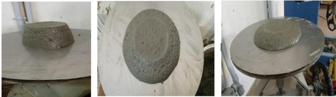
Figure III.17. L'essai de la table de secousse.
