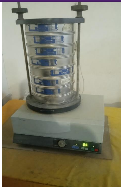
Figure III.2. Essai de l'analyse granulométrique.
