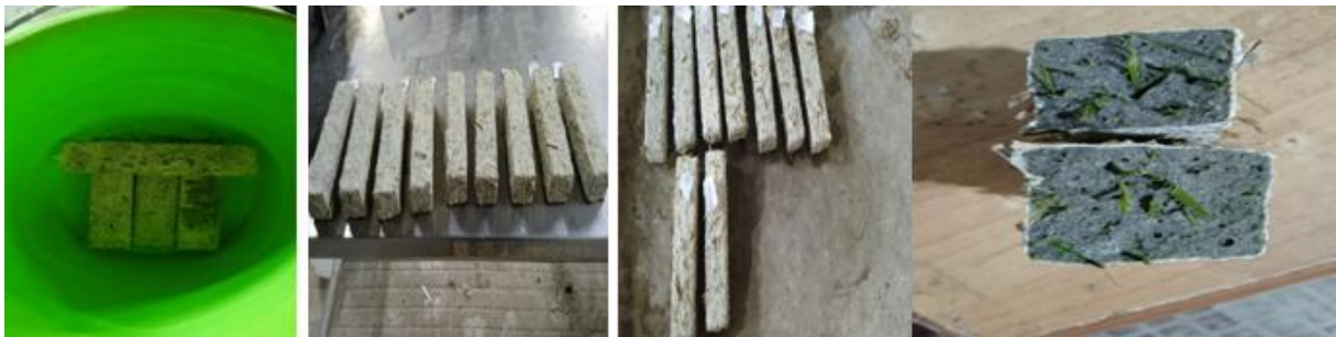
Figure III.26. Les formulations dans NaOH après 7j, 14j, 21j et 28j.
