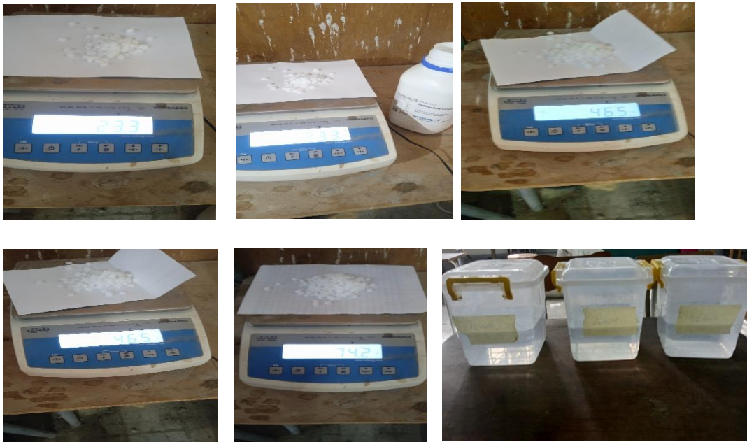
Figure III.13. Préparation de la solution de NaOH.
