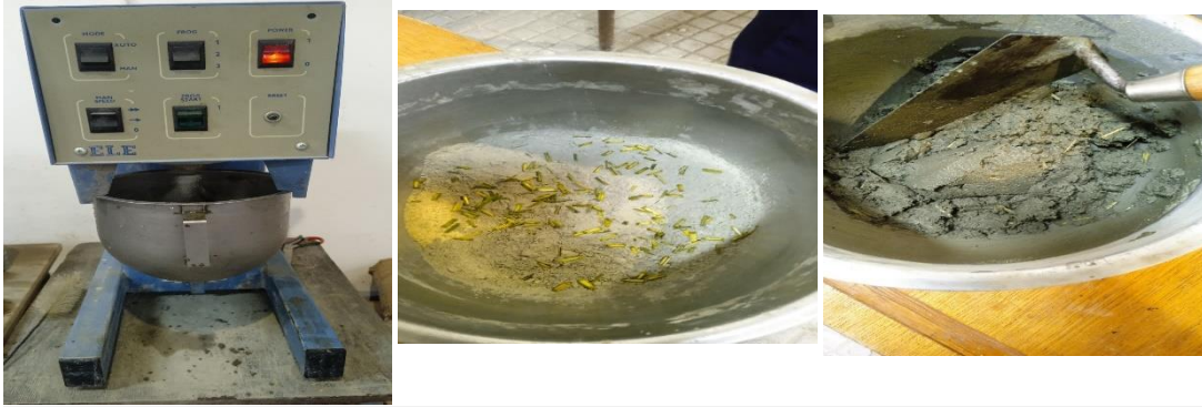
Figure III.14. Les étapes pour préparer la pâte de mortier avec différent pourcentage de fibre de
