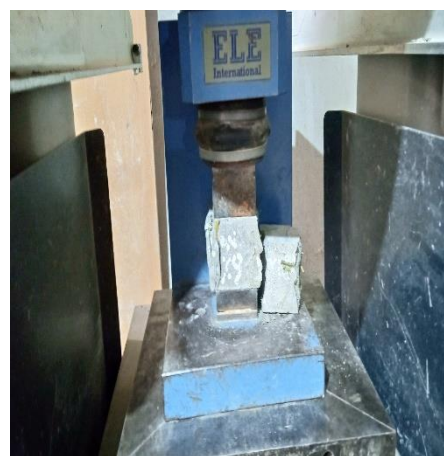
Figure III. 21. L'essai de la compression sur des éprouvettes 4 \times 4 \times 16 \text{ cm}^3 .
