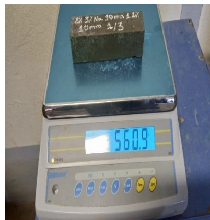
Figure III.28. Pesée à l'air.
