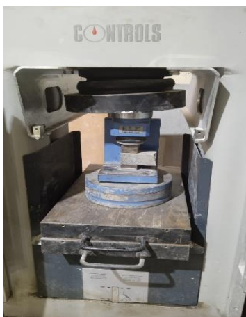
Figure III. 21. L'essai de la compression sur des éprouvettes 4 \times 4 \times 16 \text{ cm}^3 .
