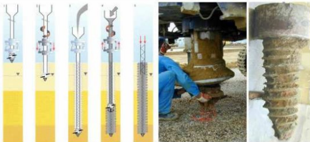
Figure II. 8. Pieu vissé à pointe perdue Atlas.
