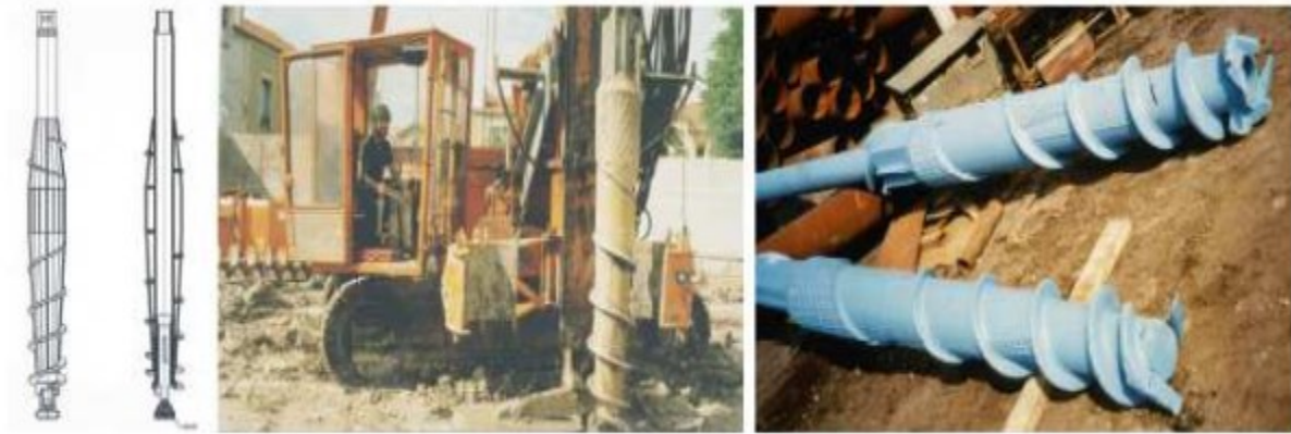
Figure II. 9. Pieu vissé de type Oméga à deux pas de vis ou un seul.
