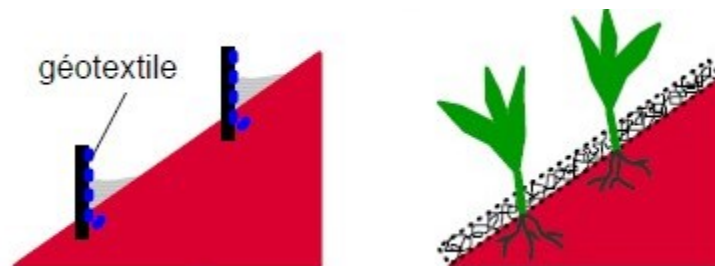
Figure I. 21. L'utilisation contre l'érosion.
