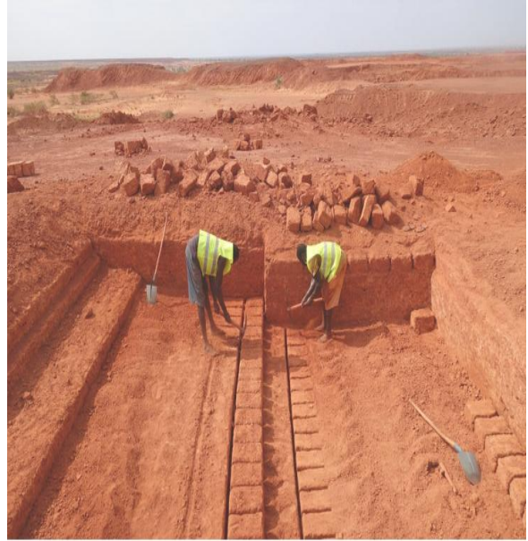
Fig 1.12 Extraction de blocs en terre découpée
