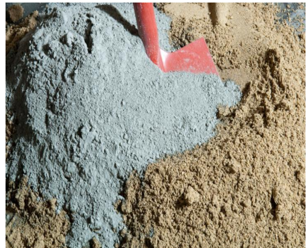
Fig 2.4 Stabilisants chimiques avec le ciment
