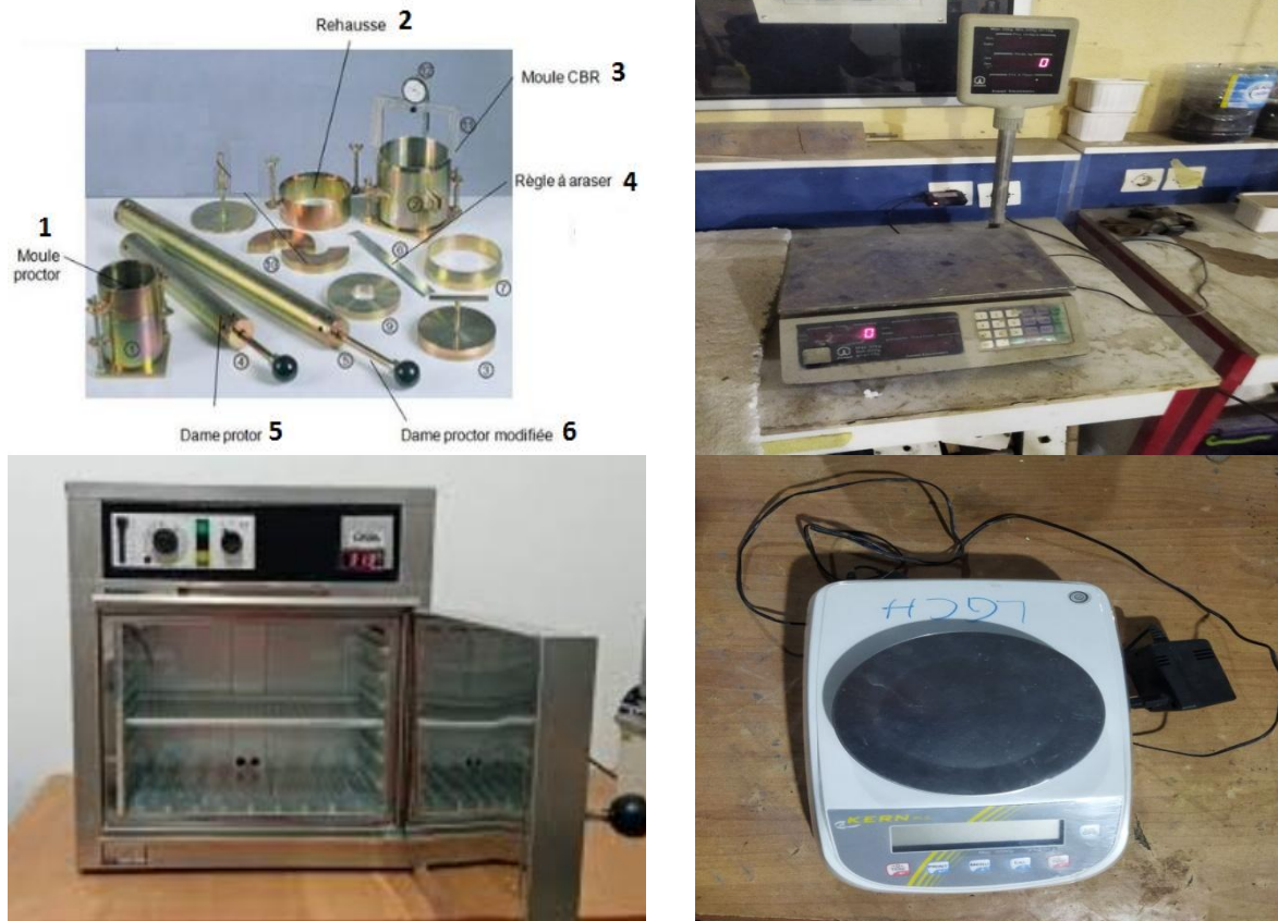
Fig 3.12 Matériel nécessaire pour essai Proctor
