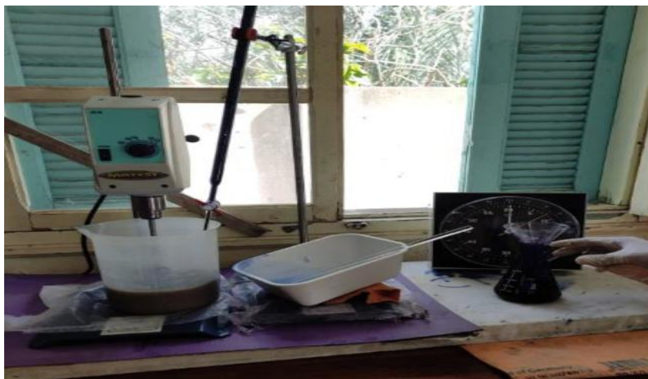
Fig 3.7 Matériel nécessaire Essai au bleu de méthylène
