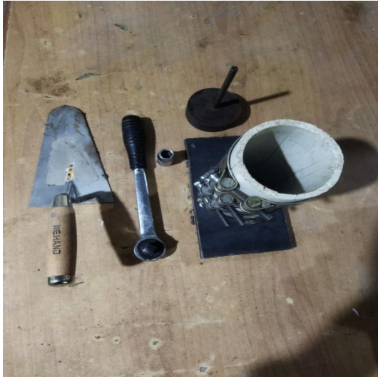
Fig 3.3 moule en PVC pour confection d'éprouvette
