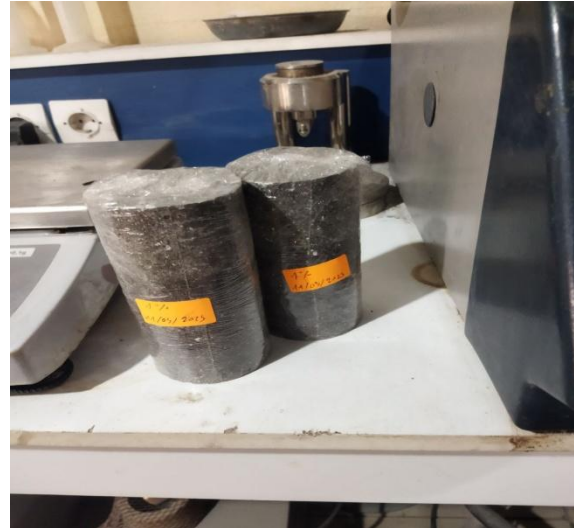
Fig 3.4 les éprouvettes compactées et sceller dans papier film
