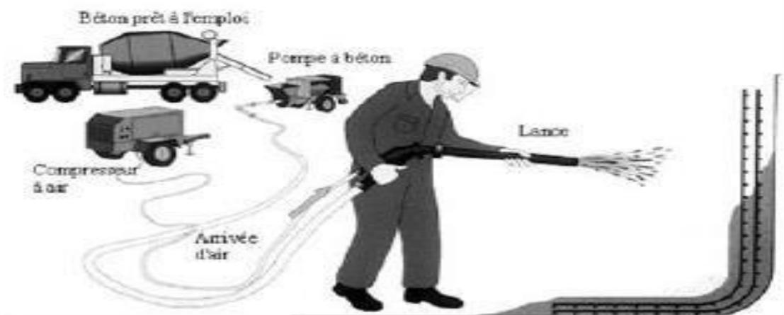
Figure I.7 : Projection par voie humide.
