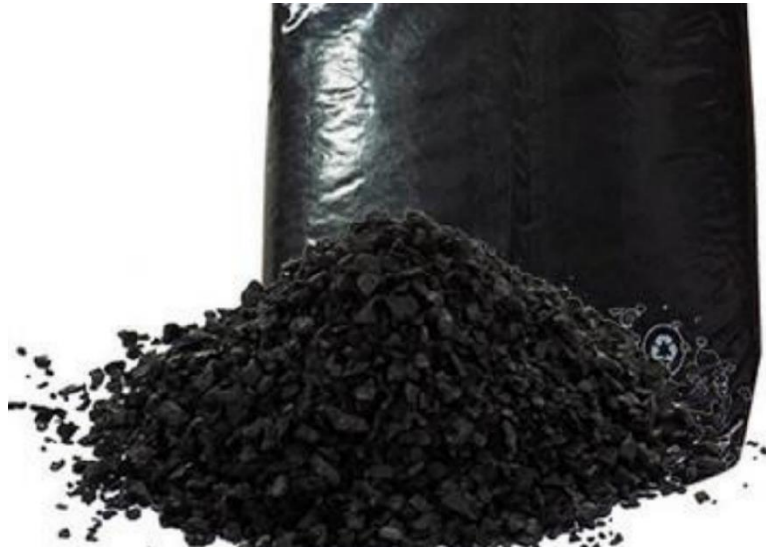
Figure 31 : Charbon actif de la station El Maouane.
