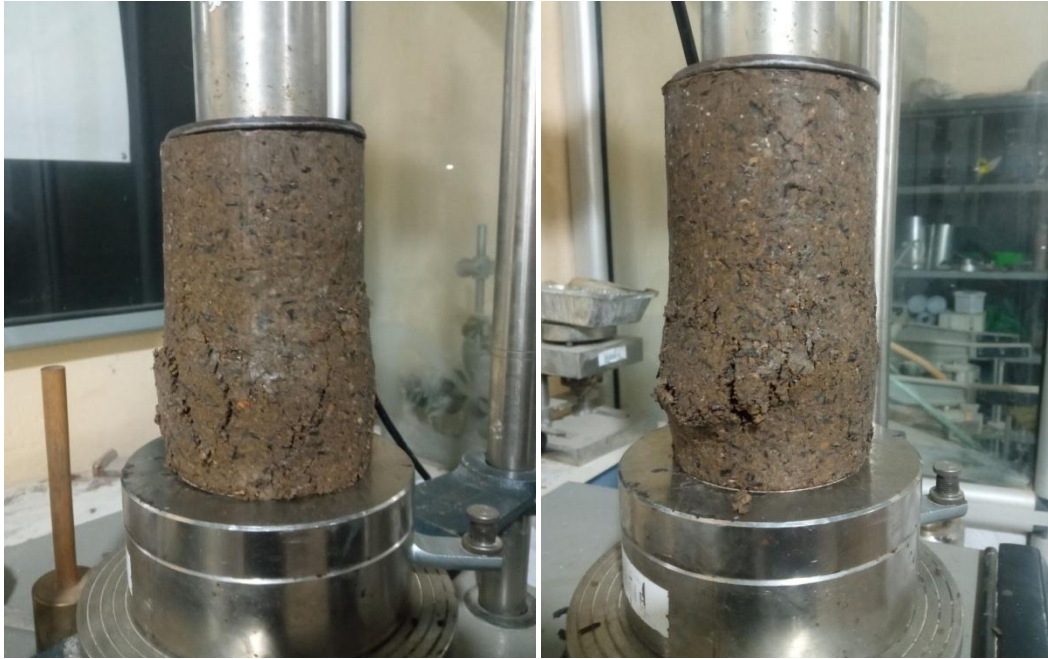
Figure VI.13 : Rupture des éprouvettes traitées sous la compression simple à 28 jours.
