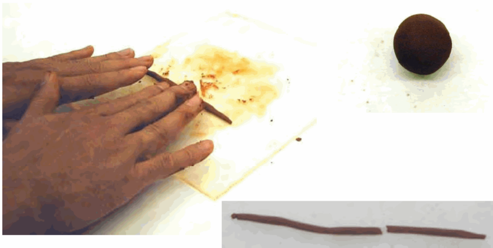
Figure IV.5 : Limite de plasticité Wp par la méthode au rouleau.
