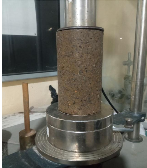
Figure V.8 : Préparation et rupture de l'éprouvette à la compression simple.
