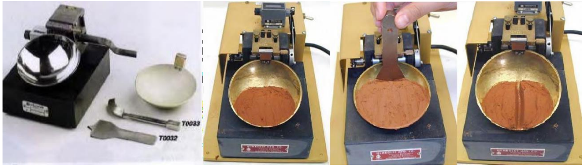
Figure IV.4 : méthode de Casagrande.
