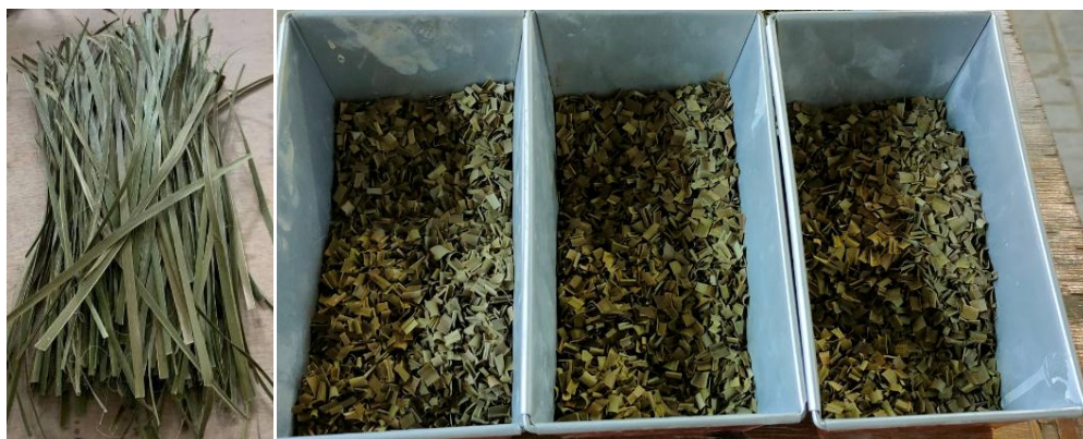
Figure VI.2 : Découpage de feuilles de palmier en morceaux de longueur (5mm, 10mm et 15mm).
