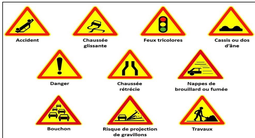
Figure IV- 8: Panneaux Signaux des dangers
