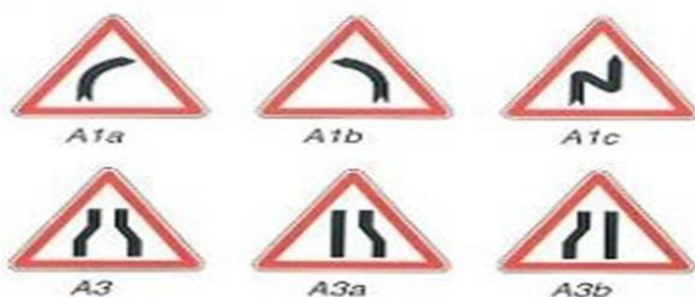
Figure IV.10: Signalisation verticale type A.
