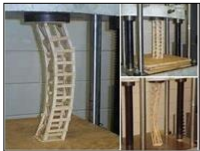
Figure III.2 : Essai de Flambement d'un poteau en laboratoire.
