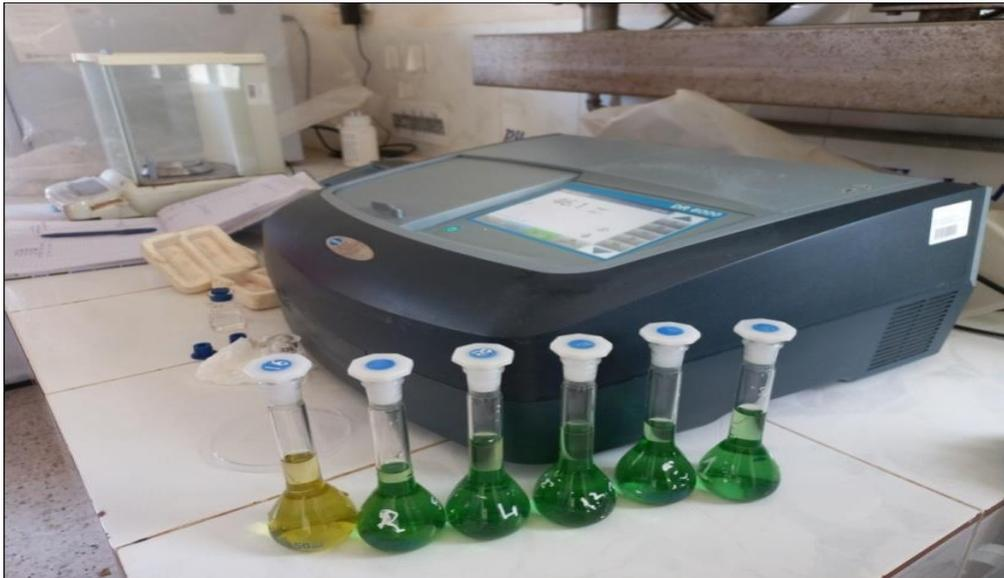
**Figure 04:** résultats d'ammonium à partir d'un Spectrophotomètre.
