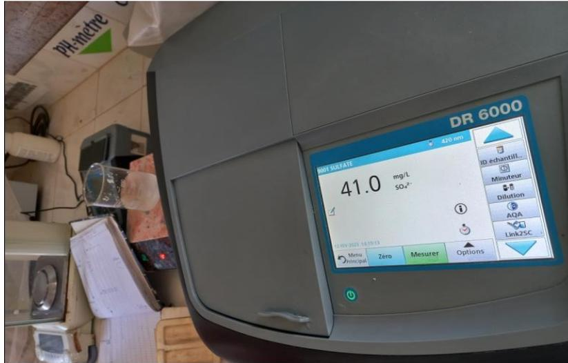
**Figure 03:** résultats des sulfates à partir d'un Spectrophotomètre.
