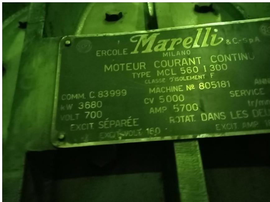
Figure II. 8 La plaque signalétique d'un moteur à CC du GI.
