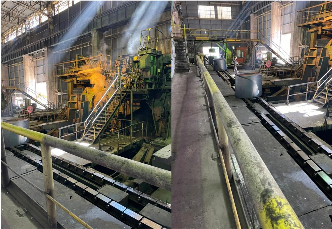
Figure I. 8 La bobineuse et le produit finale.
