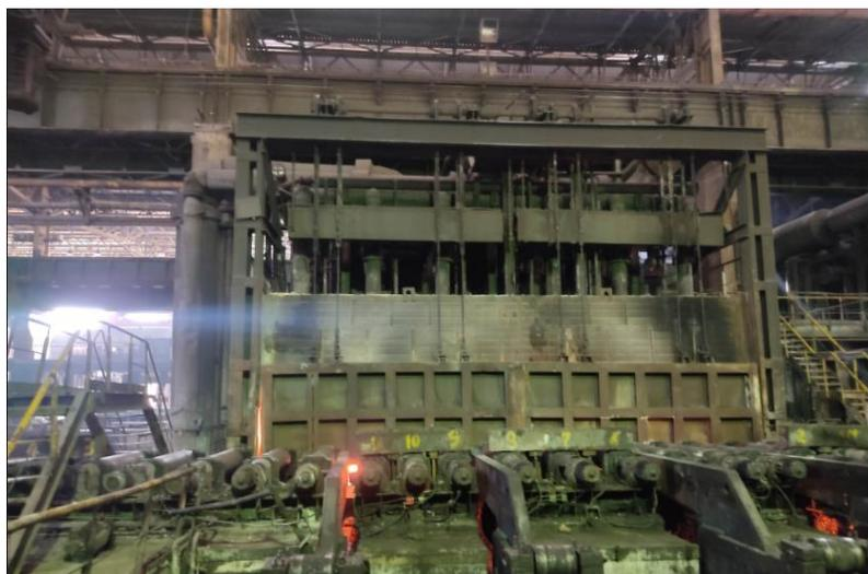
Figure I. 4 Un four de réchauffage des brames.
