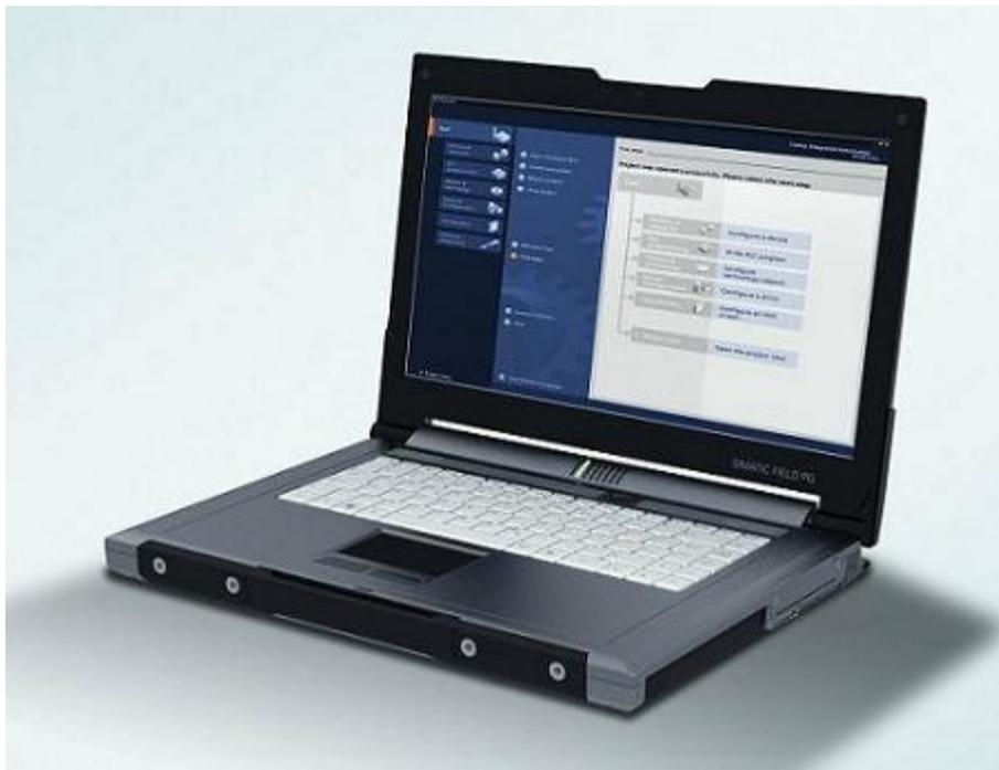
Figure III. 2 Laptop PG de siemens.
