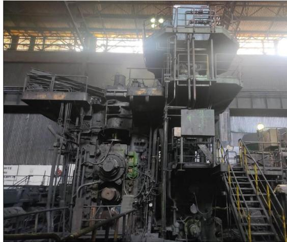
Figure I. 5 Une brise à oxydes.
