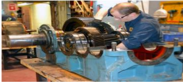
Figure II.18 : Photographie d'un réducteur de vitesse [16].
