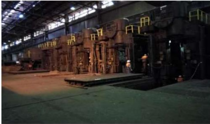
Figure I.17 : Train finisseuse (6 cages).
