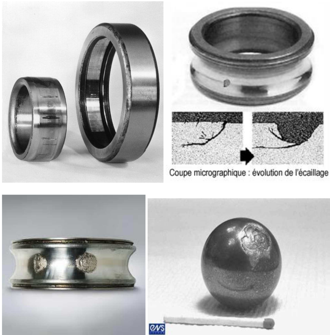
Figure 1.1. Défauts de roulements [3]
