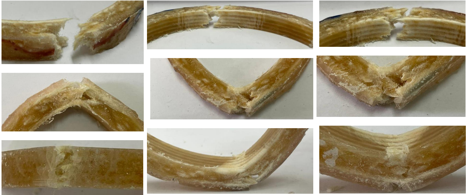
Figure 3.2 : Faciès de rupture des éprouvettes 3, 3 et 2 impactées respectivement à leurs surfaces extérieures, intérieures et latérales de leur face.
