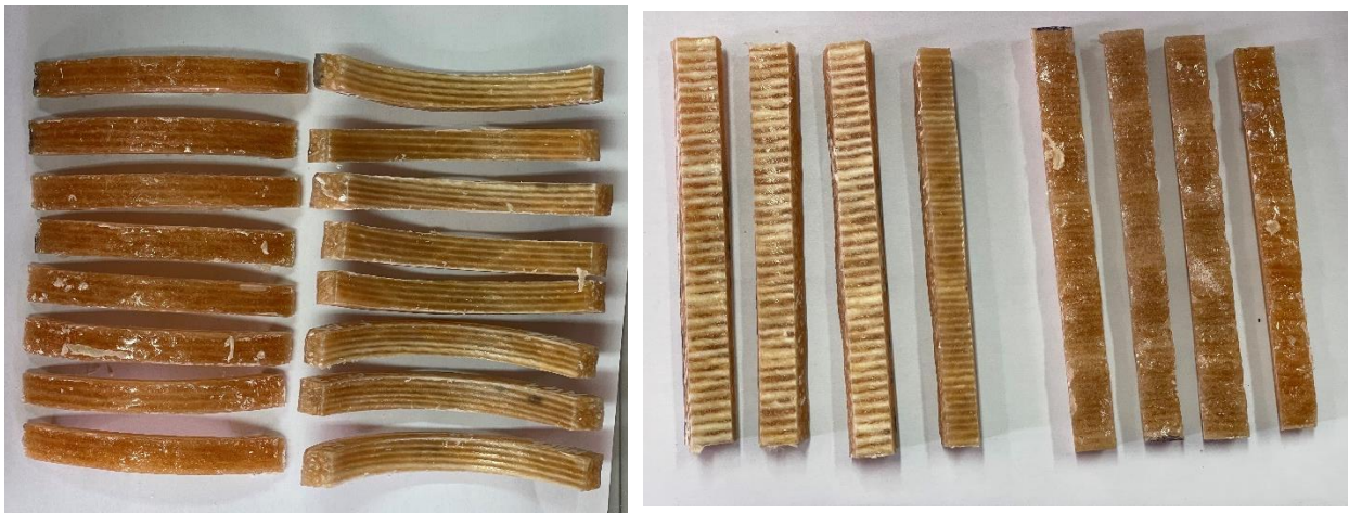
Figure 2.8: Exemple d'éprouvettes découpées pour les tests de résilience et de flexion.
