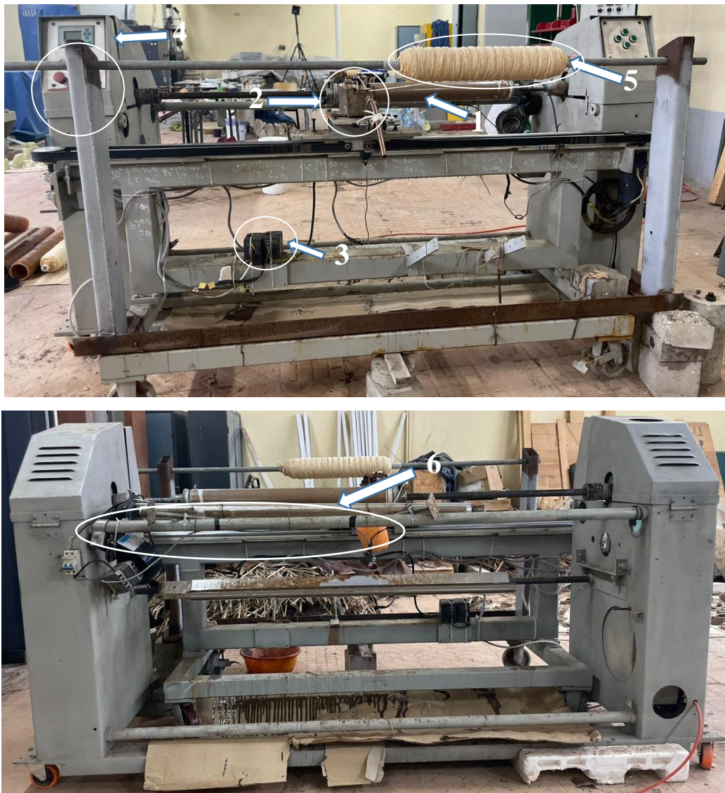
Figure 2.1 : Machine d'enroulement filamentaire (LMANM de l'Université 8 Mai 1945 Guelma).
