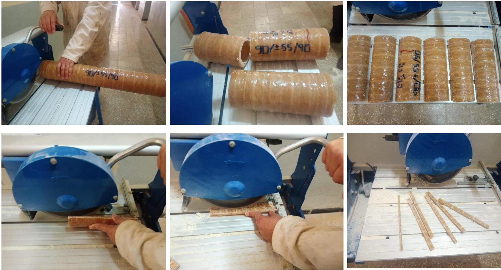
Figure 2.7: Découpe des tubes en éprouvettes pour les tests de résilience et de flexion de résine 2
