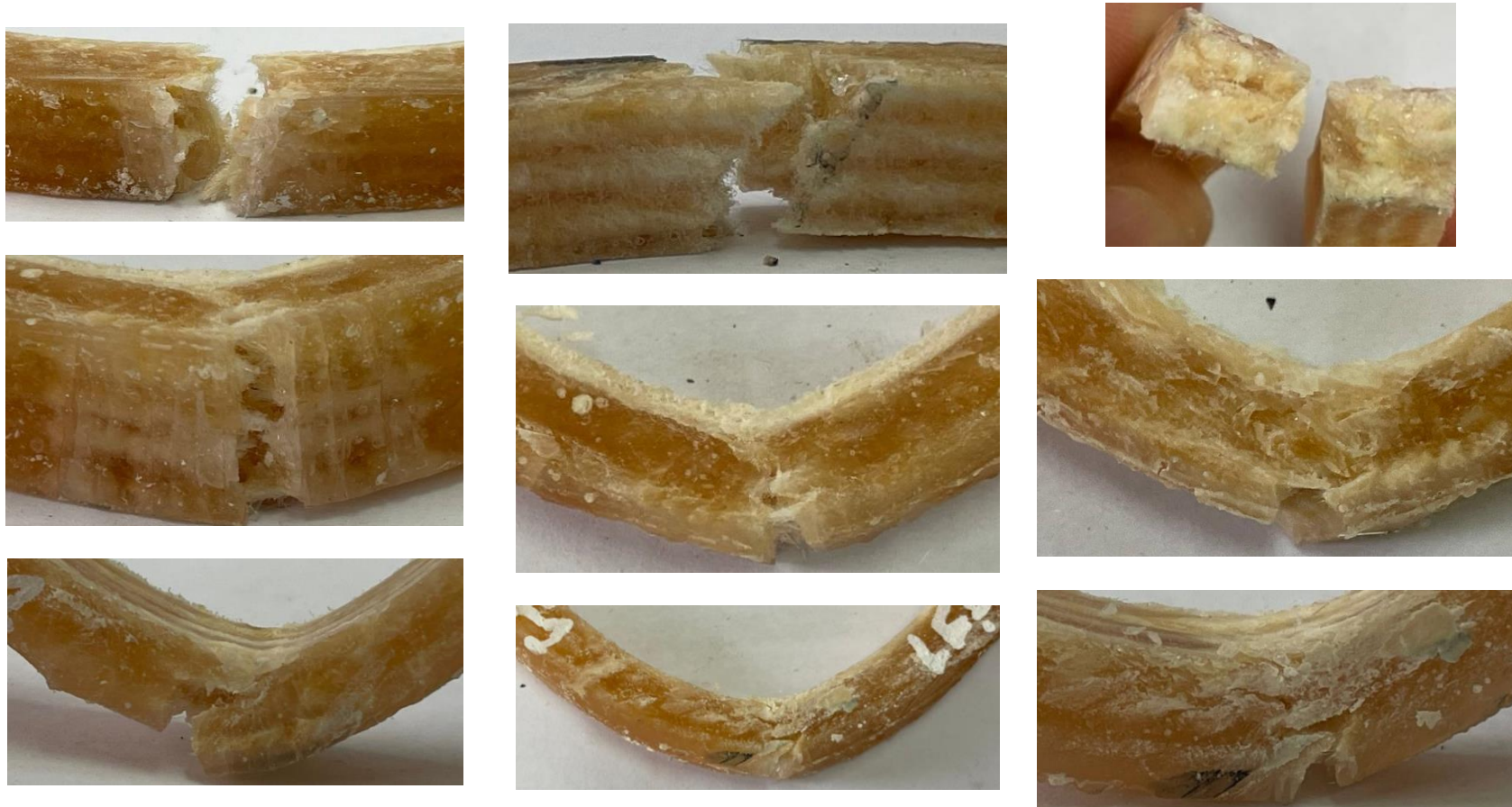
Figure 3.1 : Faciès de ruptures des éprouvettes 1 et 4 et 3 impactées respectivement à leur faces intérieure, extérieure et latérale
