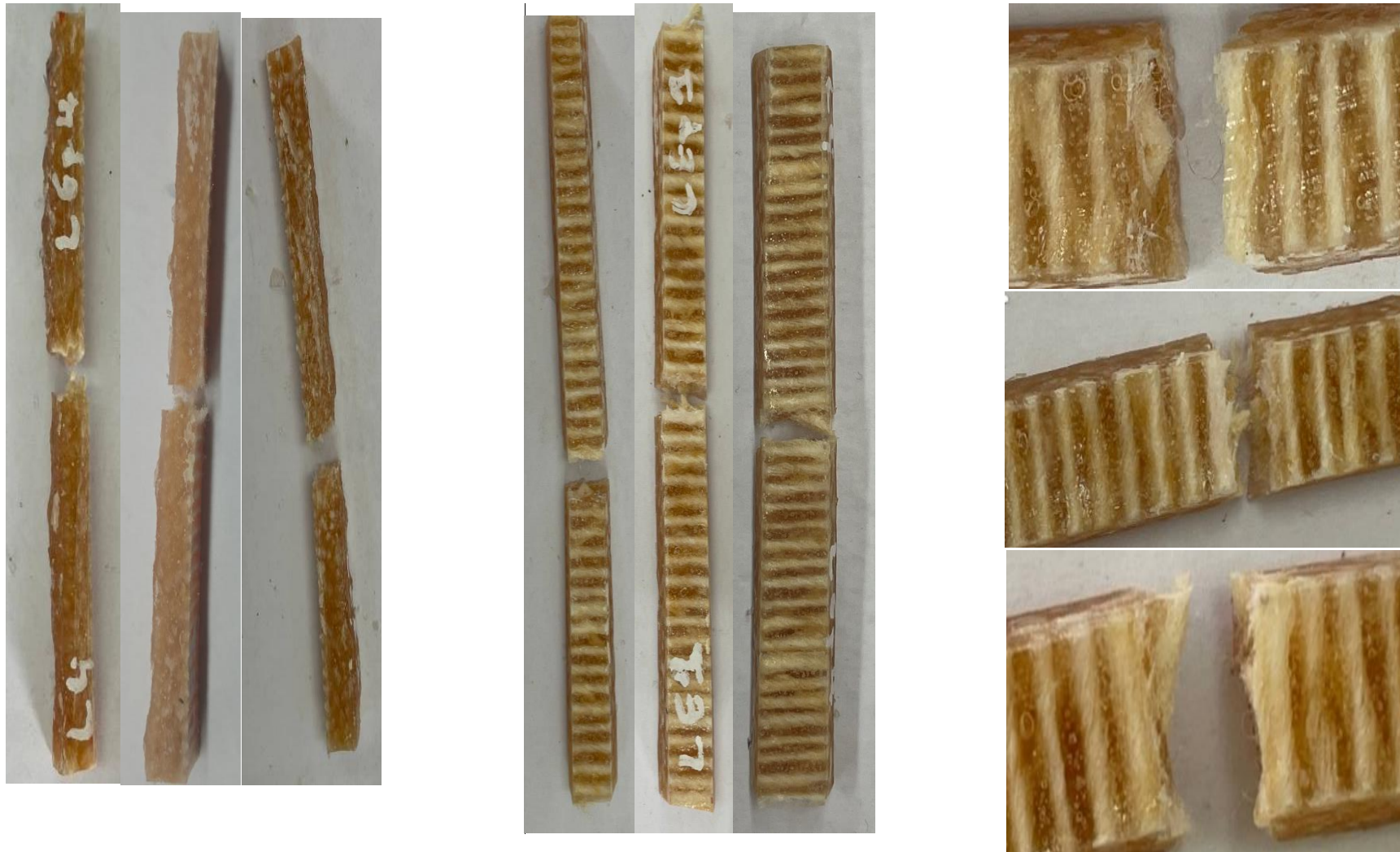
Figure 3.3 : Faciès de rupture des éprouvettes 1, 1 et 4 impactée respectivement à leurs surfaces extérieures, intérieure et latérale.
