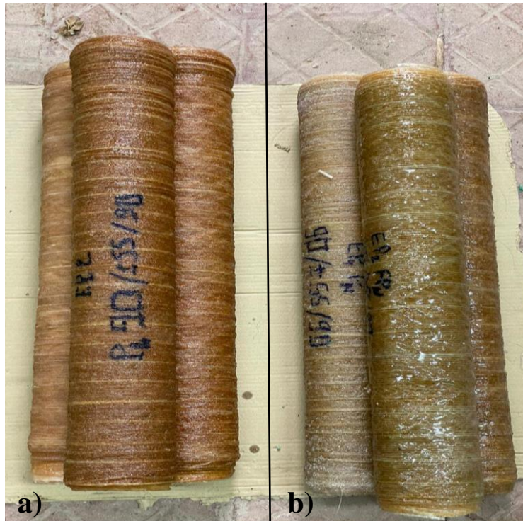
Figure 2.4 : Tubes composite élaborés par la: a) résine 1 et b) résine 2.
