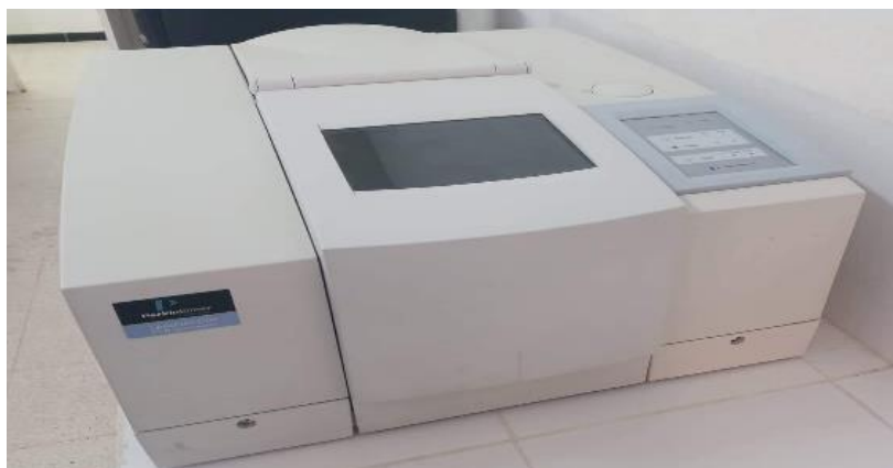
Figure III.16. Spectromètre FT-IR Perkin Elmer
