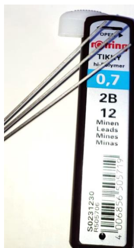
Figure III.6. Photographie des mines de graphite (électrode de travail)
