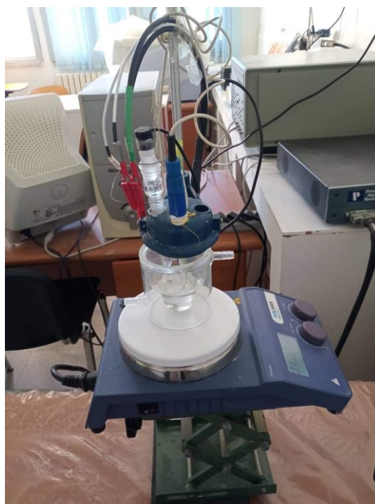
Figure III.3. Cellule électrochimique [Laboratoire d'Analyses Industrielles et Génie des Matériaux (LAIGM)].
