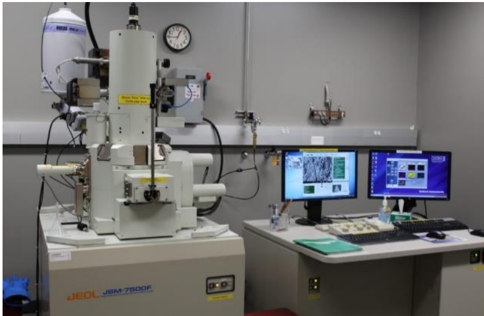
Figure III.9. Microscope électronique à balayage JEOL. JSM – 7500F
