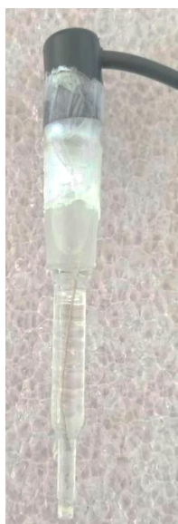
Figure III.4. Photographie de l'électrode de référence (ECS : Hg/Hg 2 Cl 2 /KCl) [Laboratoire d'Analyses Industrielles et Génie des Matériaux (LAIGM)]
