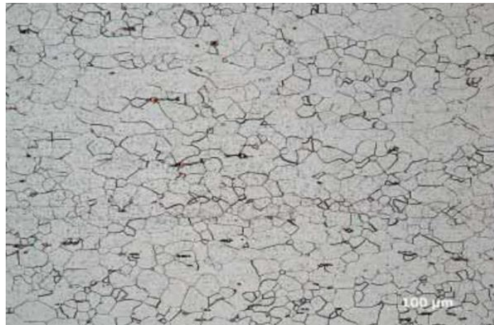
Figure II.10. Métallographie d'un acier inoxydable ferritiques [30]
