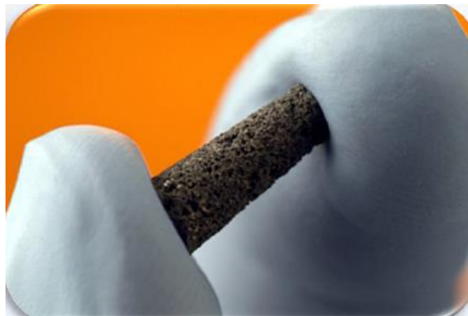
Figure II.15. Prototype poreux pour implants dentaires en titane [52].
