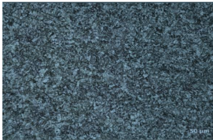
Figure II.8. Métallographie d'un acier martensitique [30]
