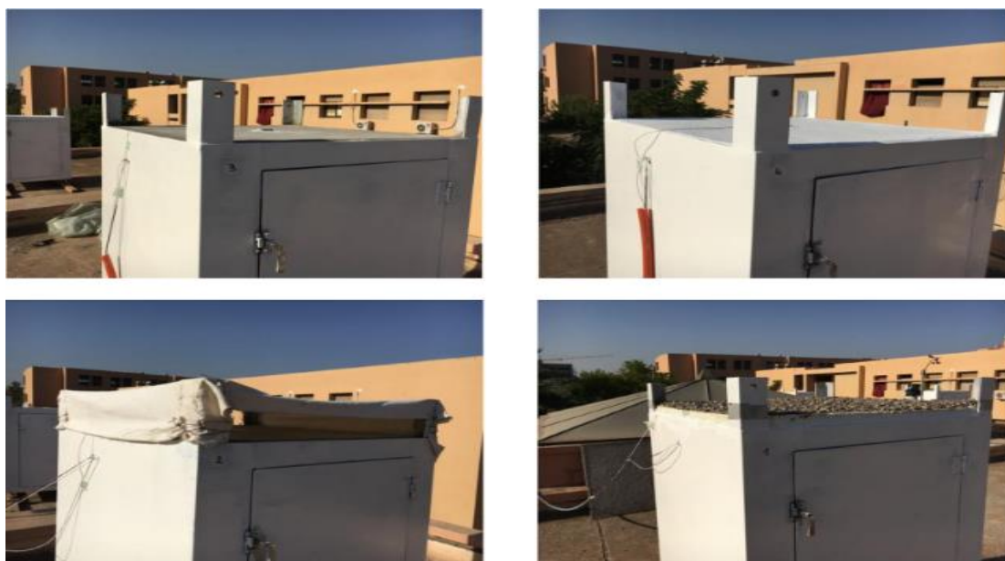
Figure III.29 : Photo des cellules de test avec les techniques passives. De gauche à droite et de haut en bas : cellule de référence avec dalle nue, dalle peinte en blanc, toiture ombragée et toiture isolée thermiquement (Kachkouch et al., 2018)
