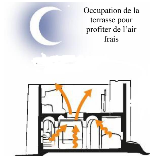
Figure IV.18 : Stratégies passives d'aération, de ventilation et d'ensoleillement de la maison ksourienne (Schéma adapté par OPVM, 2018)
