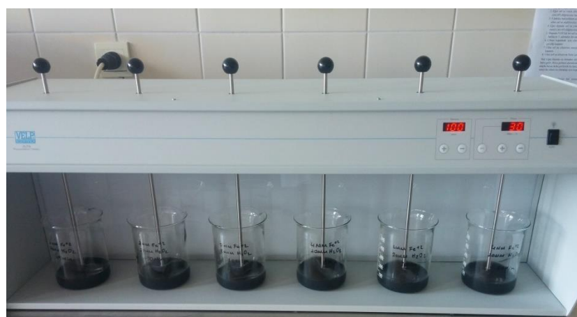
Figure 0-18 : Elimination du H_2O_2 résiduel après l'oxydation fenton
