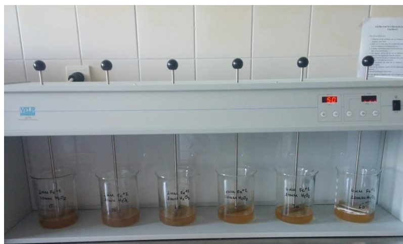
Figure 0-17 : Procédé d'oxydation Fenton de l'effluent textile
