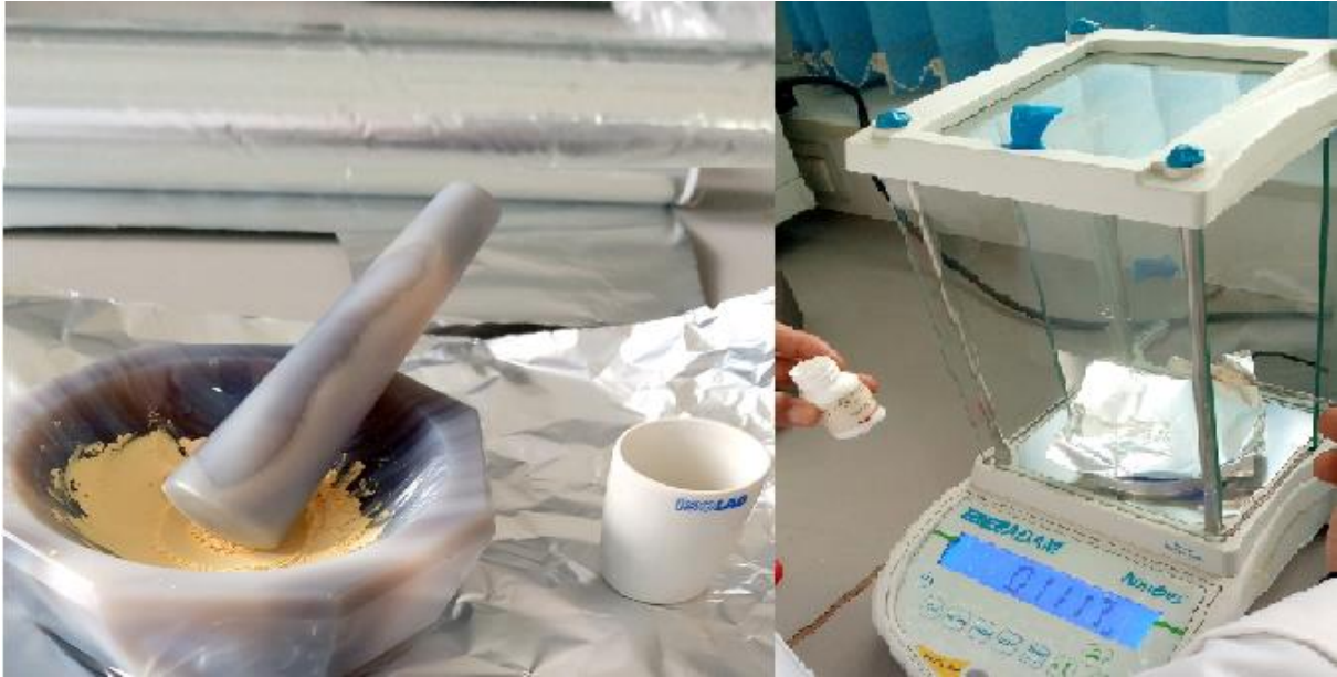
Figure III.3 : Balance de marque METTLER TOLEDO utilisée dans le but de peser les différents composés construisant le verre dopé
