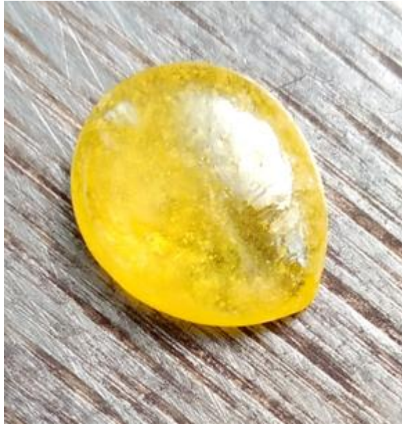
Figure III. 10 : Aspect du verre obtenu juste après trempe (avant recuit)
