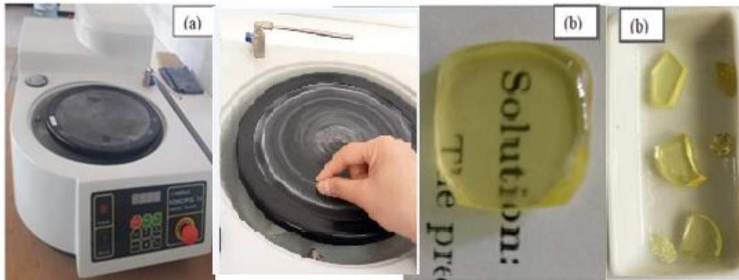
Figure III.13 : (a) Photographie de la polisseuse de marque Metkon Forcipol 1V,(b)verre Obtenu après le recuit et polissage, son forme analogue à une lame à face parallèle.
