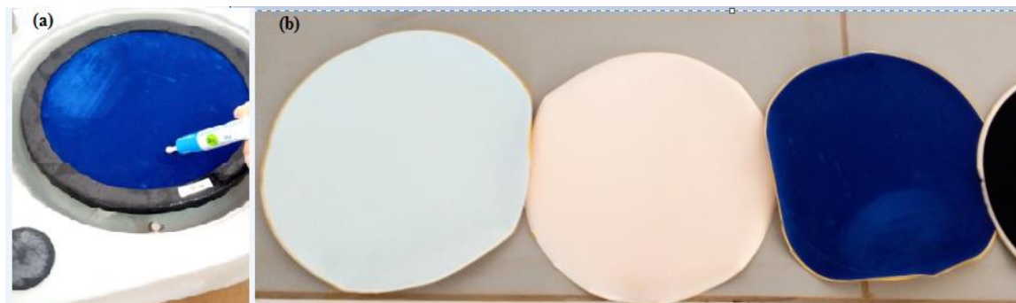
Figure III.14 : (a) Photographie de la polisseuse alimenté par un drap sur lequel on met la pate à diamant, (b) différents draps utilisés.
