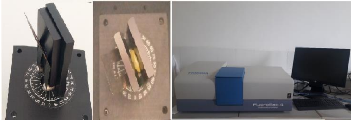
Figure III.17 : Photographie de spectrofluorémètre de marque Horiba Fluoromax-4 disponible au sein de laboratoire LAPALSO ANNABA
