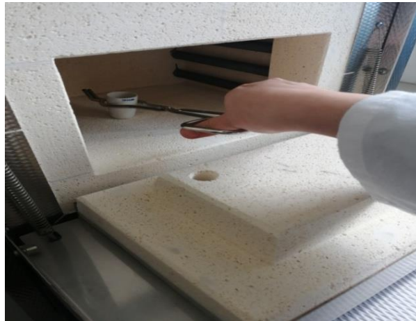
Figure III.6 : Placement du creuset dans la chambre du four à moufle à température ambiante
