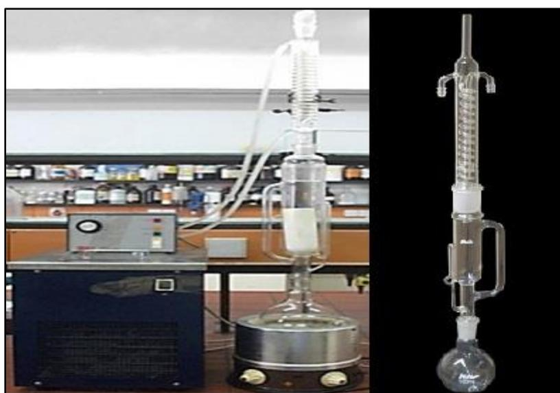
**Figure 10 :** Système d'extraction au Soxhlet (HARRAR 2012).
