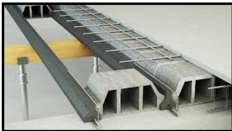
Figure (III.7) : Plancher en corps creux.
