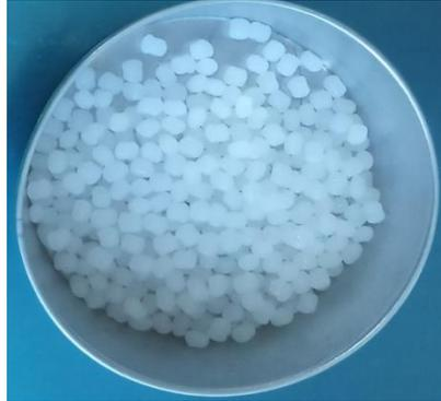
**Figure II. 8:** Photographie de matériau granulaire de polyéthylène.
