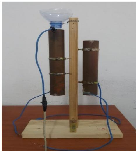
Figure II.2: Système de la décharge couronne en configuration fil-cylindre
