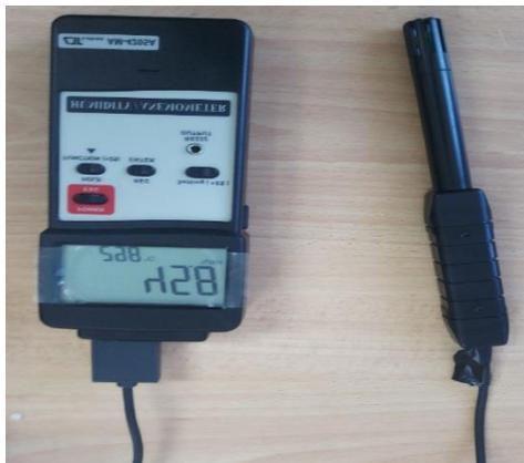
**Figure II.6:** photographie de l'hygromètre numérique.
