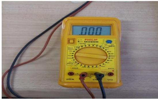
**Figure II.3:** Multimètre numérique utilisé dans la mesure du courant de décharge
