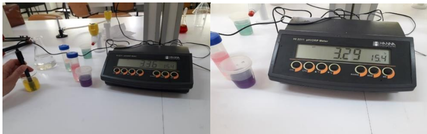
Figure 15: Détermination de pH par pH mètre (original 2022)
