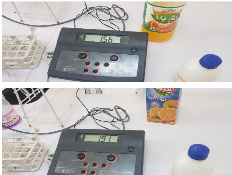
Figure 16 : Détermination de conductivité par conductimètre (original 2022)
