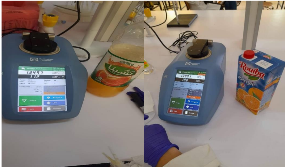
Figure 17 : Détermination de BRIX par réfractomètre (original 2022)
